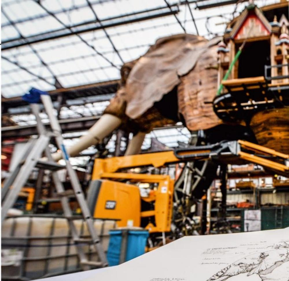
(1) Le Grand Éléphant devait se déplacer sur des rails, mais le projet a été abandonné au profit d'une démarche plus autonome avec un moteur et quatre pattes articulées. Chacun des sabots (2) pèse 250 kilos et sa trompe est animée par 23 vérins hydrauliques (3). À l'intérieur, tout rappelle Jules Verne avec une ambiance de science-fiction (4) dont peuvent profiter les passagers lors d'une parade sur les bords de Loire (5).
