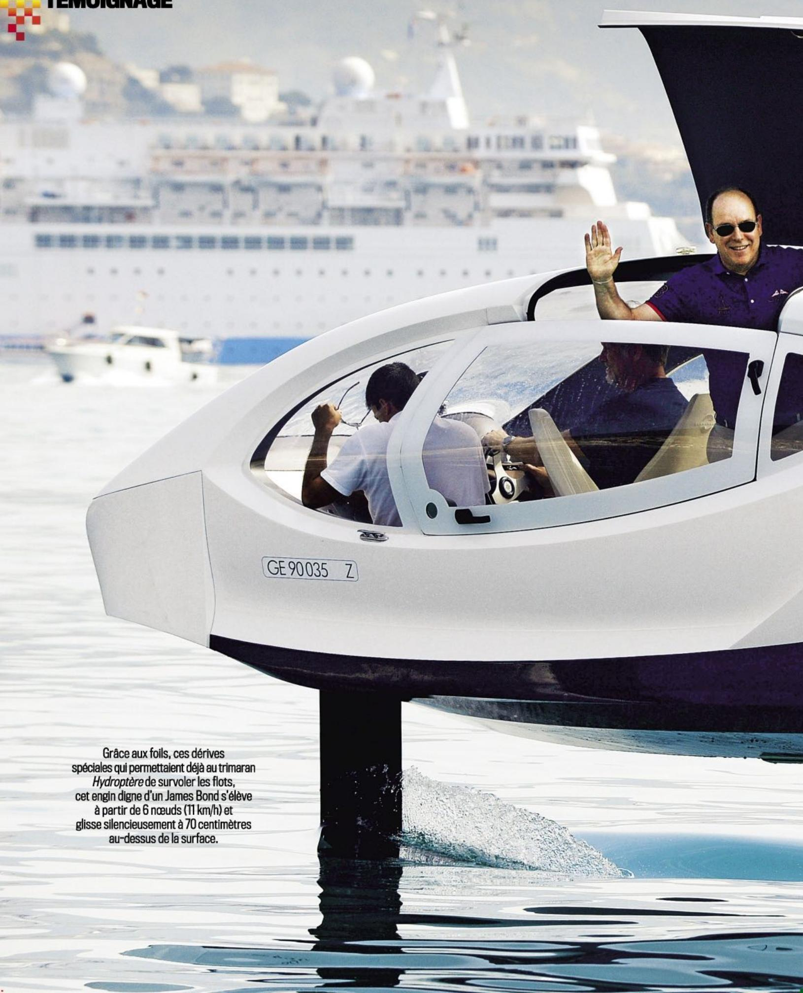
Grâce aux foils, ces dérives spéciales qui permettaient déjà au trimaran *Hydroptère* de survoler les flots, cet engin digne d'un James Bond s'élève à partir de 6 nœuds (11 km/h) et glisse silencieusement à 70 centimètres au-dessus de la surface.
