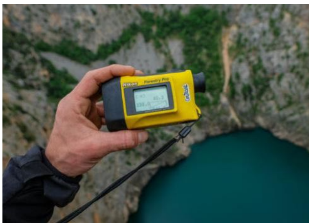
Pour régler le système de corde, l'équipe utilise un laser très précis. Ici, la mesure du saut pendulaire.
