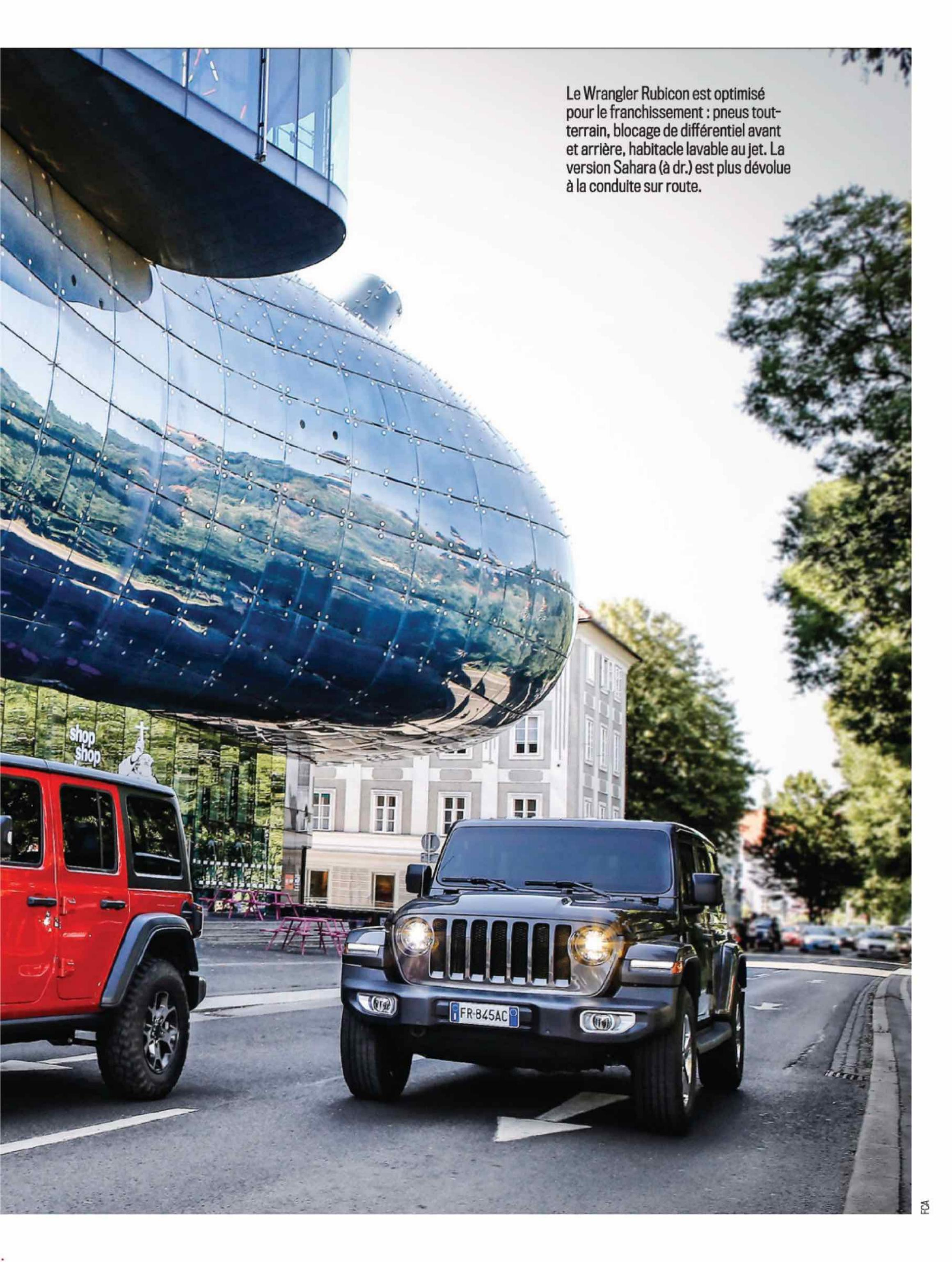
Le Wrangler Rubicon est optimisé pour le franchissement : pneus tout-terrain, blocage de différentiel avant et arrière, habitacle lavable au jet. La version Sahara (à dr.) est plus dévolue à la conduite sur route.
