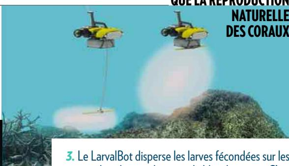
3. Le LarvalBot disperse les larves fécondées sur les zones les plus touchées par le blanchiment. « C'est un robot autonome et intelligent, piloté par iPad, capable en surface de se repérer avec son GPS, et sous l'eau grâce à sa vision, explique le Pr Dunbabin. Bientôt il pourra même détecter les zones blanchies pour y disperser lui-même les larves. »
