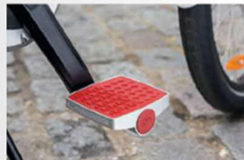
Ce nouvel équipement high-tech alerte le propriétaire sur son smartphone lorsque son vélo est déplacé, et permet ainsi de le géolocaliser à tout instant. Pour les distraits, une application permet aussi de retrouver l'endroit où le cycle a été garé. En mode marche, la pédale enregistre automatiquement chaque trajet effectué : itinéraire, distance parcourue, vitesse, dénivelé, calories consommées. Économie, elle génère sa propre énergie et dispose de sa propre connexion Internet.
