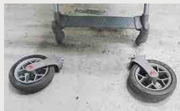
Le test de résistance a été fatal aux roues avant de la Maclaren Techno XT.
