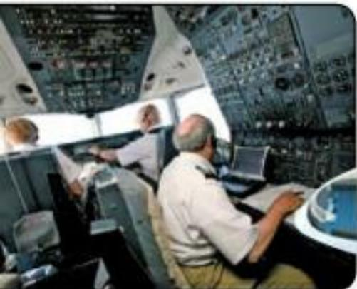
**Le cockpit** contient 3 sièges pour l'équipage et 2 pour des observateurs.
