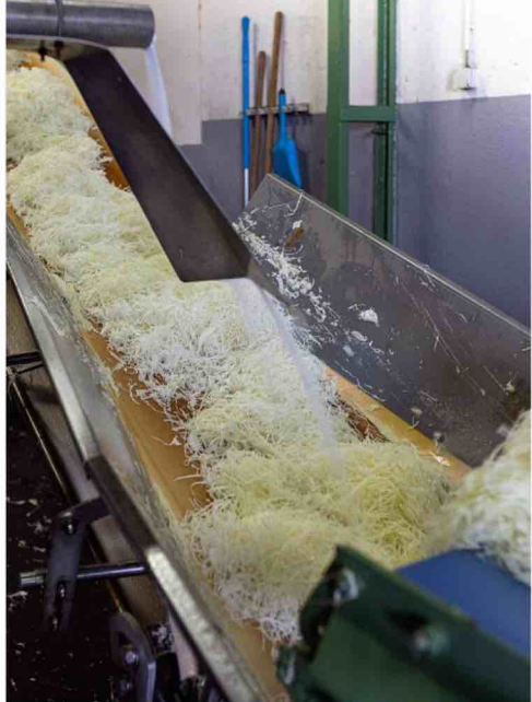
Le chou ciselé passe sous une pluie fine de sel nécessaire pour fabriquer et conserver la choucroute.
