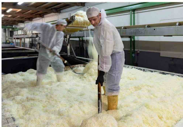
Dès que les grandes cuves où le chou est ensilé sont pleines, elles sont bâchées et la fermentation peut débuter.
