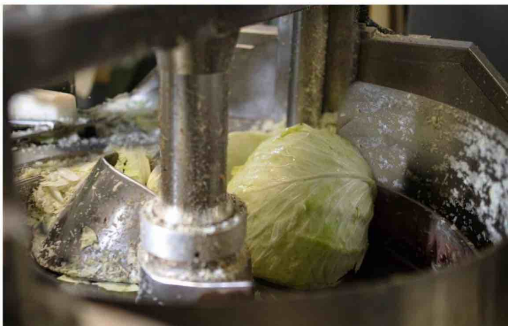
L'arrivée des choux à la choucrouterie. La machine à râper émince le chou en fines lanières grâce à ses lames qui tournent à pleine vitesse.
