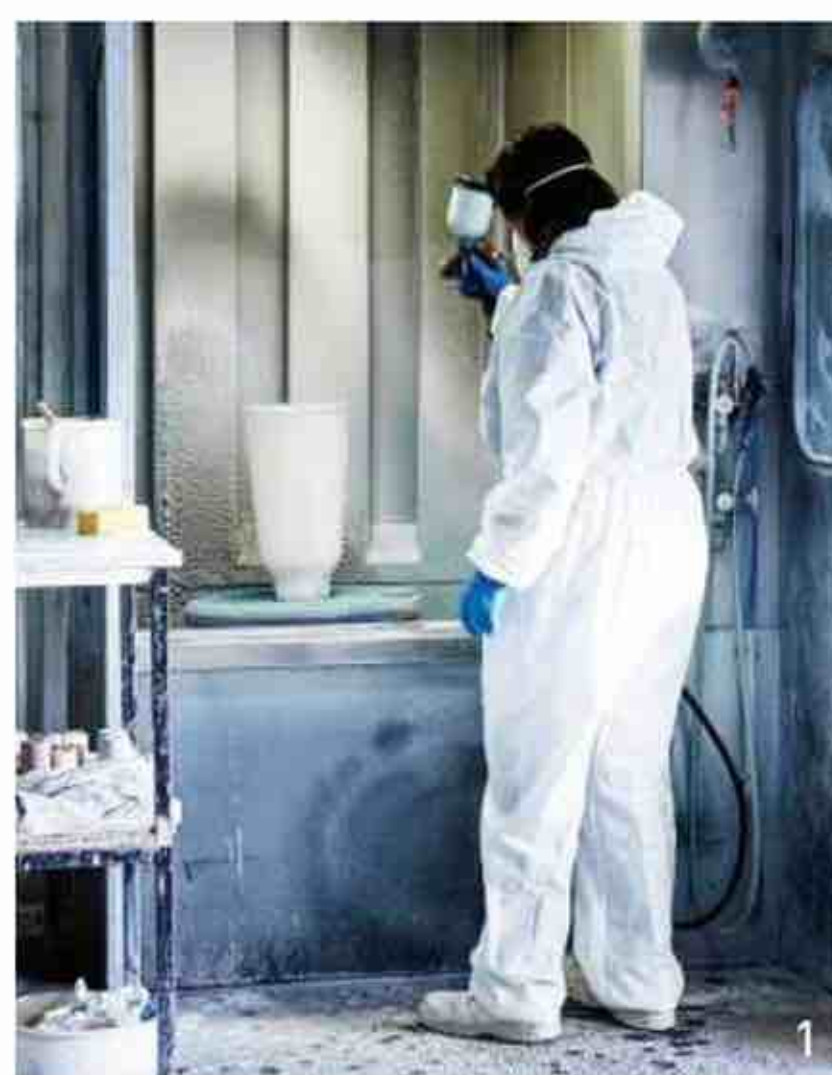
1. Émaillage du piètement de la table « Tandem » (pied blanc renversé sur le plan de travail) dessinée par Aurélie Richard.
