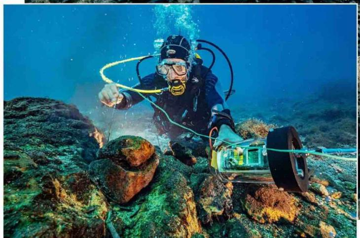
Le chercheur Thomas Grab effectue un relevé de température à la sortie d'un fumeur gris, une cheminée hydrothermale projetant de l'eau chaude et du gaz. Le thermomètre affiche 129,8 °C, mais la chaleur se dilue si vite que l'opération peut être réalisée sans gants.
