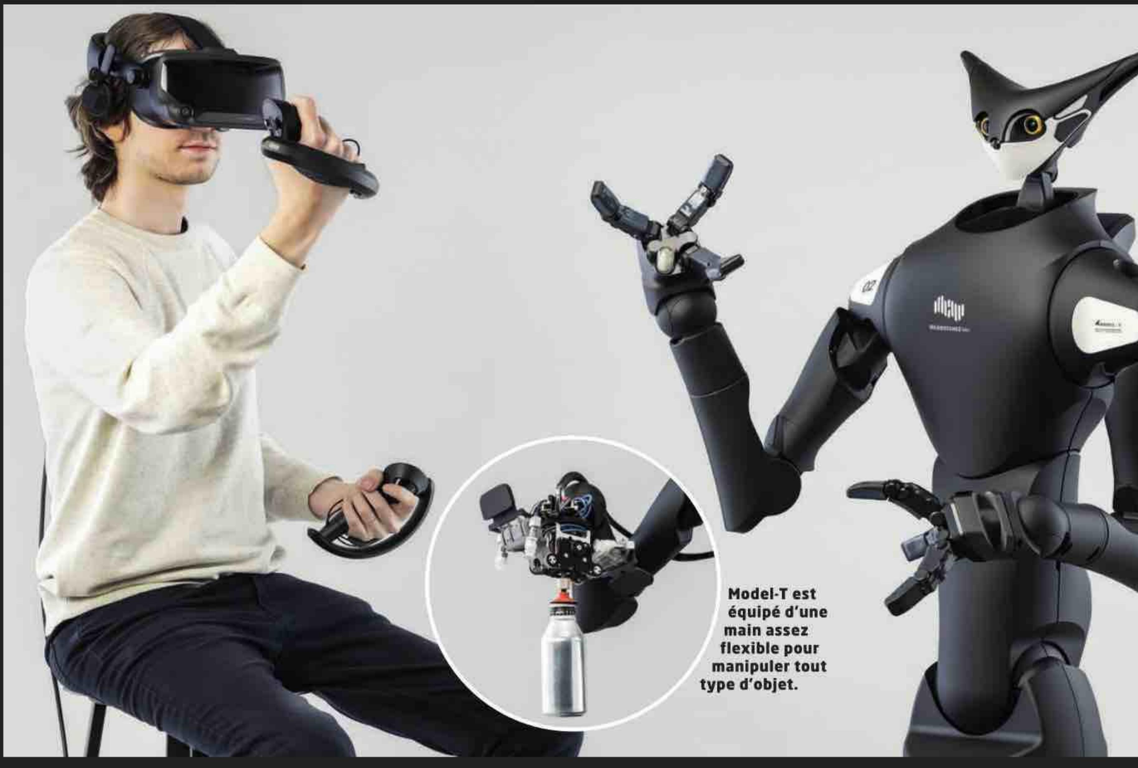
Model-T est équipé d'une main assez flexible pour manipuler tout type d'objet.
