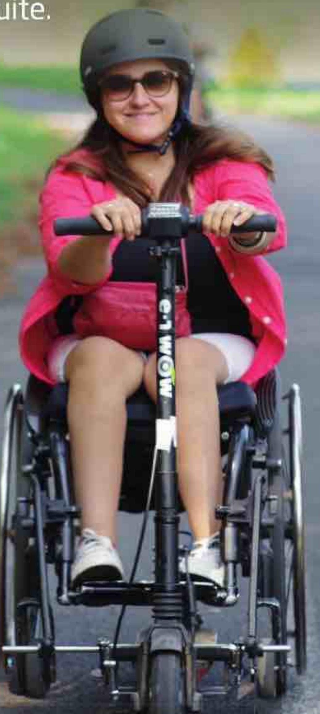
Le socle de Globetrotter se fixe sur la trottinette et permet au fauteuil roulant de s'enclencher dessus.
