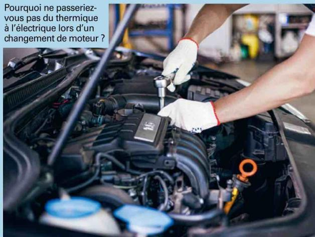
plus écologique ? Depuis avril 2020, il est légalement possible en France de remplacer un moteur thermique par son équivalent électrique. Cela s'appelle du retrofit ou conversion électrique. Cette opération consiste à débarrasser le véhicule de son moteur et de toute la chaîne de traction (le pot d'échappement, le réservoir...), puis à les remplacer par un moteur électrique et des batteries.
