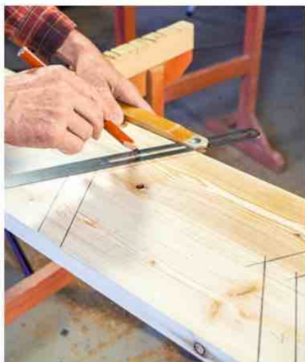
1 Accolez les limons et tracez les rainures en miroir à l'aide d'une fausse équerre. L'angle choisi est de 60°. La hauteur des marches est de 280 mm.
