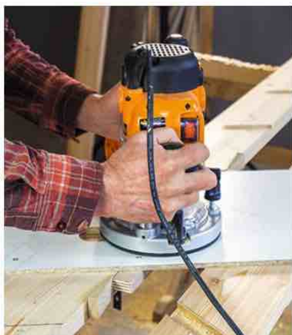
4 Bloquez le gabarit sur le limon en alignant la lumière sur le tracé. Bridez-le avec des serre-joints, rapides de préférence. Réglez la profondeur de plongée et creusez les rainures.
