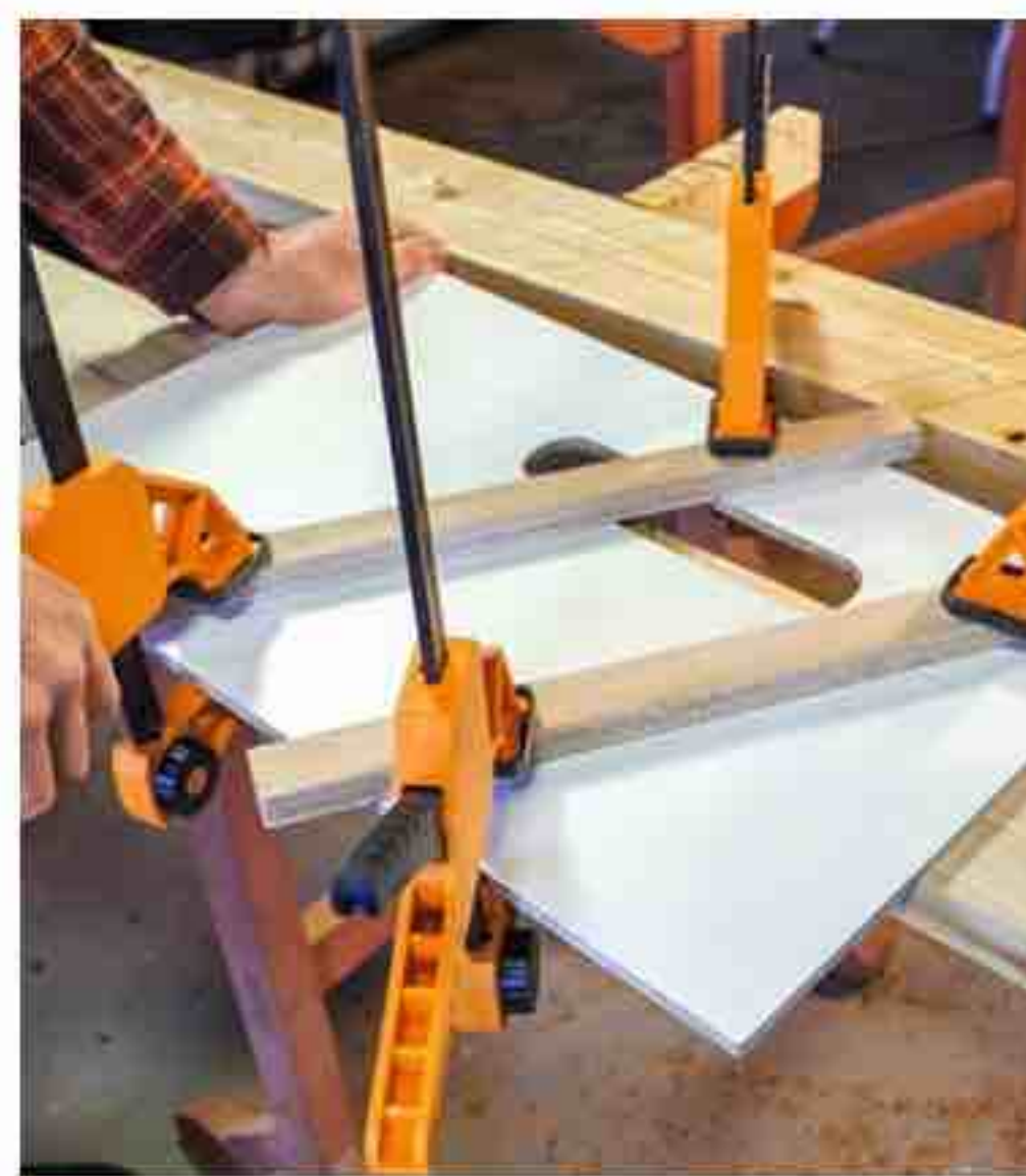
3 Le gabarit se compose d'un panneau comportant une lumière et de deux tasseaux inclinés à 60°, espacés de la largeur des limons. La lumière détermine la course de la bague de copiage.
