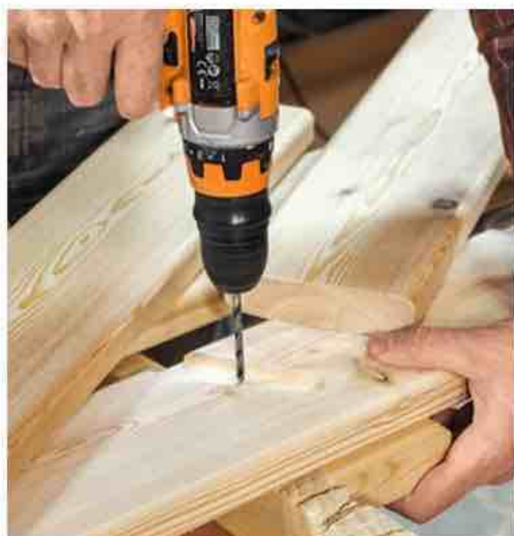
7 Poncez marches et limons en vérifiant le bon ajustement des pièces. Percez au diamètre 5 mm au centre de chaque rainure avec une mèche à bois.
