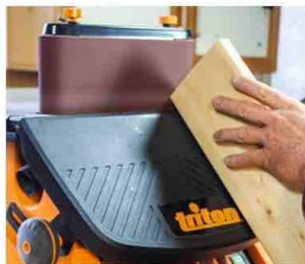
6 Chanfreinez les angles sortants à l'avant des marches, dont les nez dépassent des limons. Une ponceuse à bande stationnaire est l'outil idéal pour ce travail.
