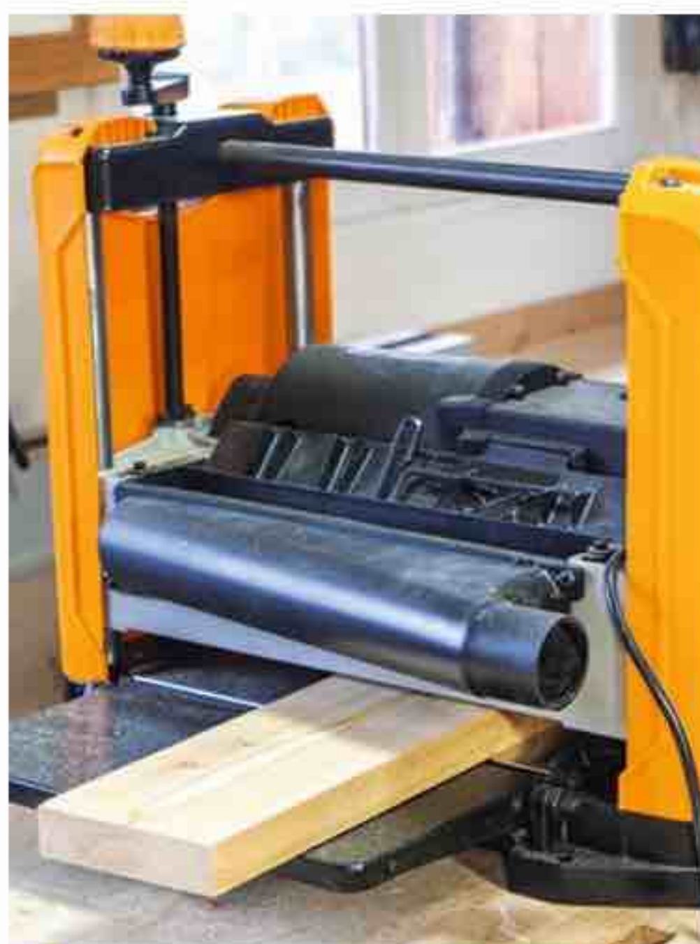
5 Rabotez les marches de manière à ajuster leur épaisseur à la largeur des rainures. Puis, avec une fraise quart-de-rond montée sur la défonceuse, adoucissez les arêtes.
