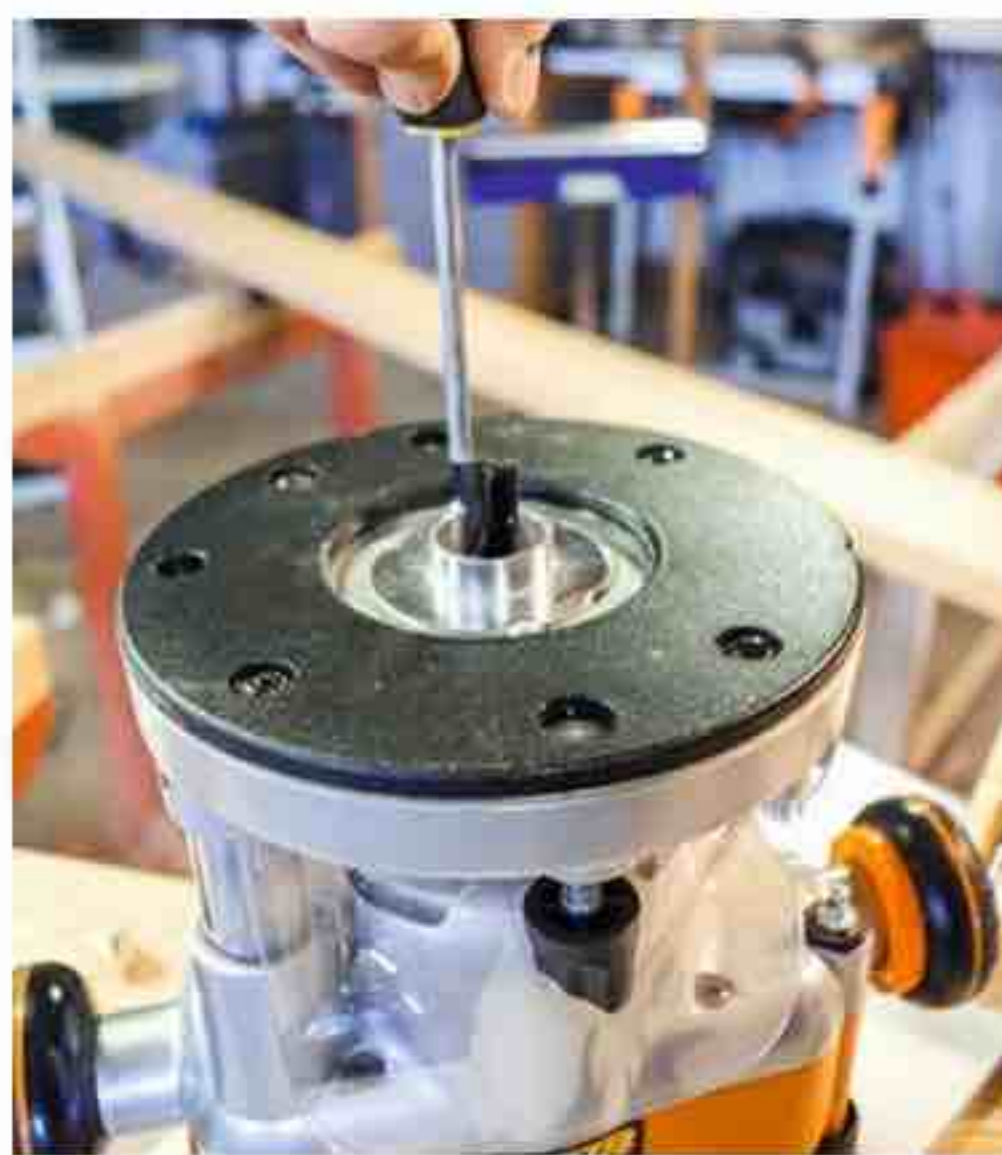
2 Serrez une fraise droite dans la pince porte-outil de la défonceuse, puis placez une bague de copiage sous la semelle de la machine.
