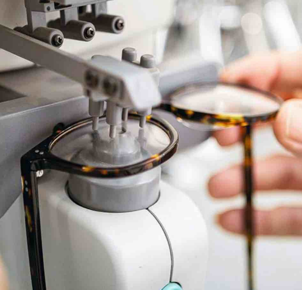
Ci-dessus, un frontofocomètre, l'outil qui sert aux opticiens à mesurer la puissance d'un verre.
