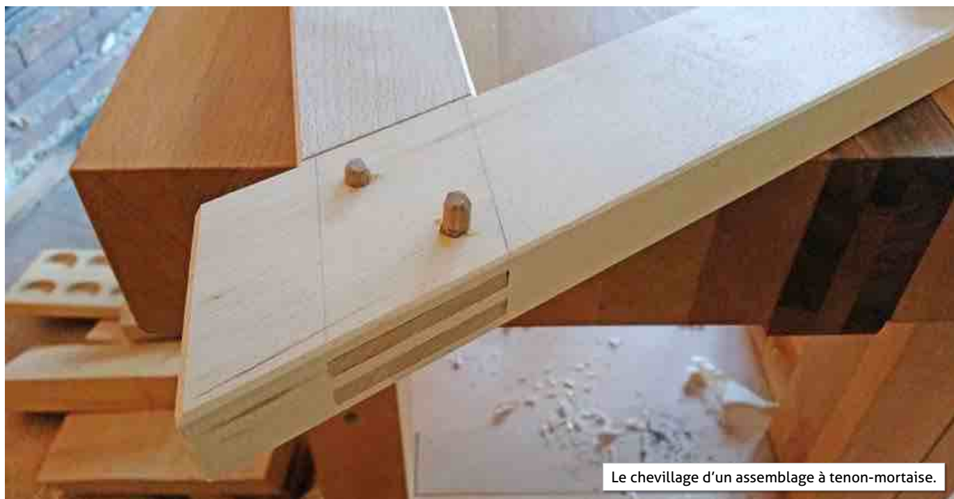
Une fois la colle sèche, on procède à l'arasement des chevilles à l'aide d'une scie à araser.
