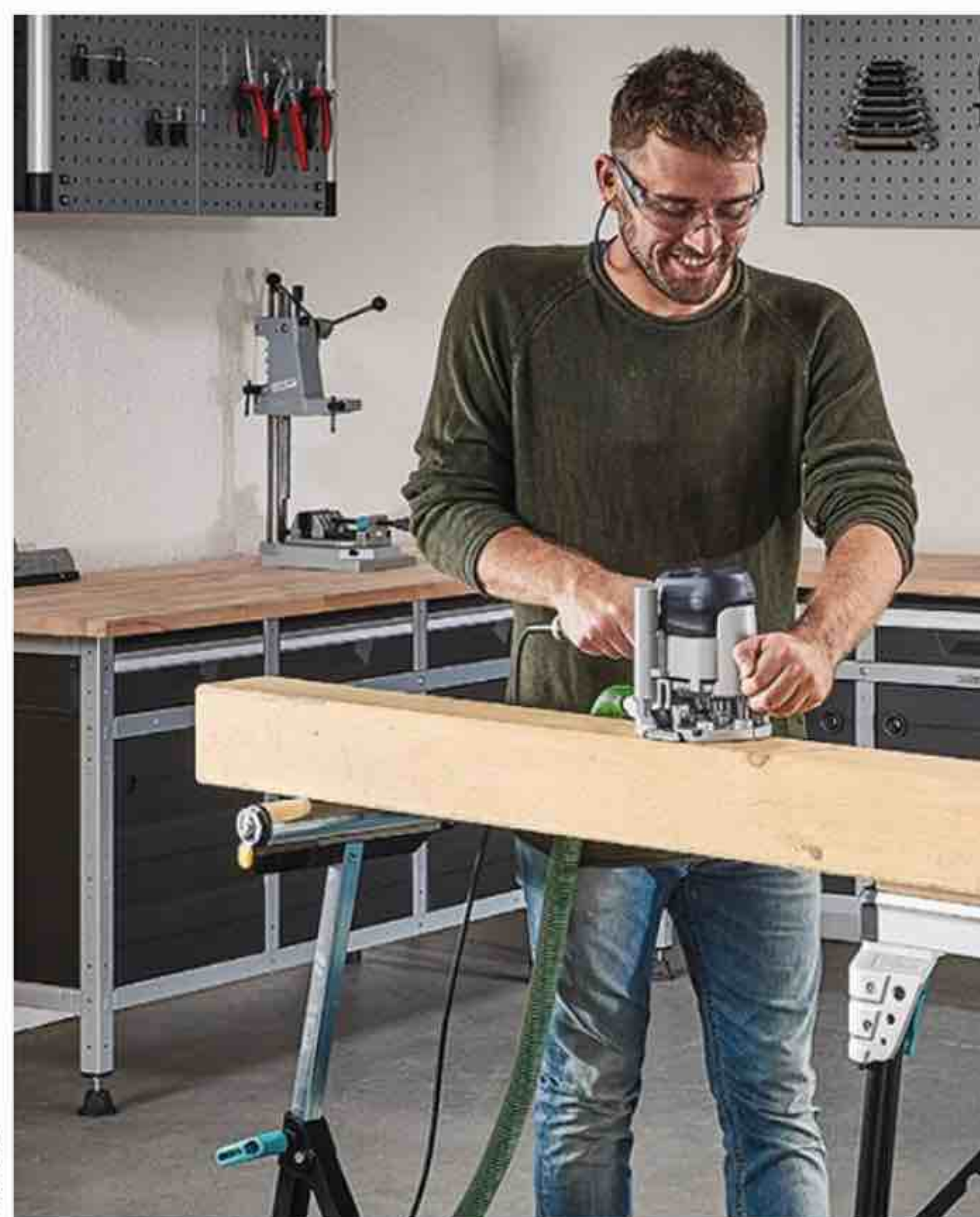
6 La servante à rouleau supporte de longues pièces en les orientant dans le sens de l'usinage. Réglable en hauteur, elle permet de les aligner de niveau avec le plateau de n'importe quel modèle d'établi.
