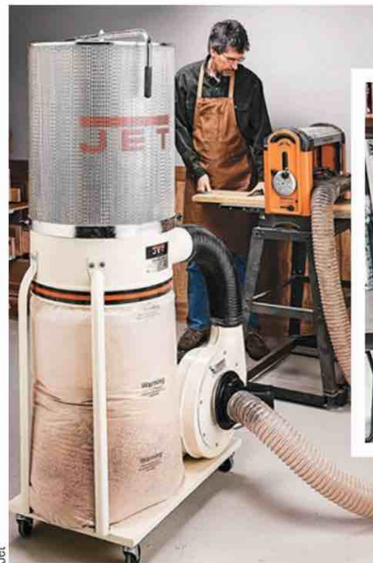
8 Raccordable aux machines à bois, ce système d'aspiration en continu fonctionne selon la technologie «Vortex-Cone» de séparation des copeaux. Muni d'un sac collecteur de 200 litres, sa puissance de dépression exclut les risques de colmatage.
