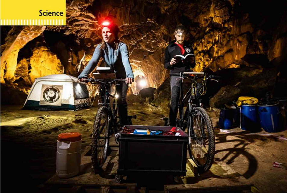
Pour alimenter les batteries du mât de lumière, des ordinateurs et des équipements, les participants pédalaient tous les jours, chacun leur tour, sur deux vélos reliés à des accumulateurs.
