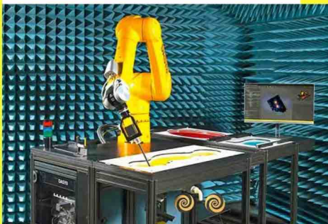
Ci-dessus, le type de banc actuellement utilisé pour les mesures de DAS (Speag DASY8) ; un bras articulé porte une sonde plongée dans une substance qui simule le liquide cérébral ou le tissu musculaire. Le banc ART-MAN procède autrement, par un balayage de mesures autour du téléphone. Cette procédure offre l'avantage d'être beaucoup plus rapide.
