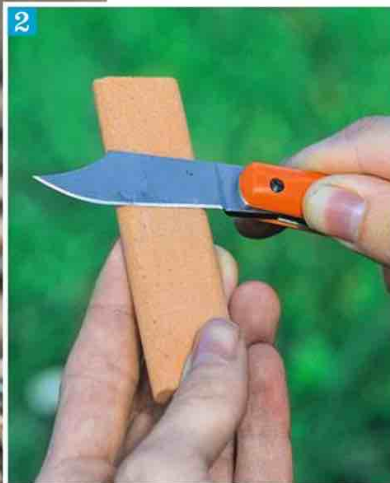
2 Affûtage d'un greffoir avec une barre de corindon (très abrasif).
