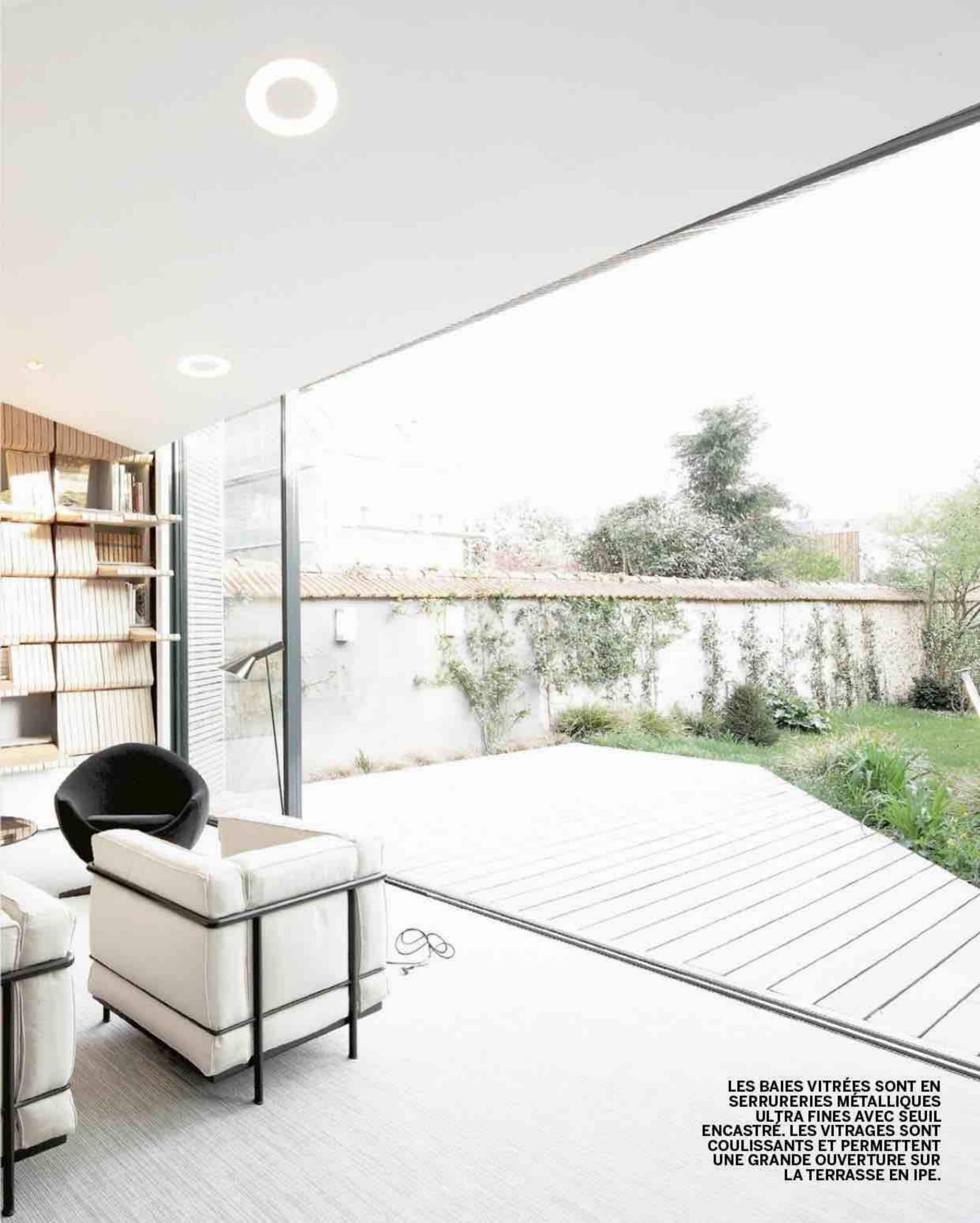
LES BAIES VITRÉES SONT EN SERRURERIES MÉTALLIQUES ULTRA FINES AVEC SEUIL ENCASTRÉ. LES VITRAGES SONT COULISSANTS ET PERMETTENT UNE GRANDE OUVERTURE SUR LA TERRASSE EN IPE.
