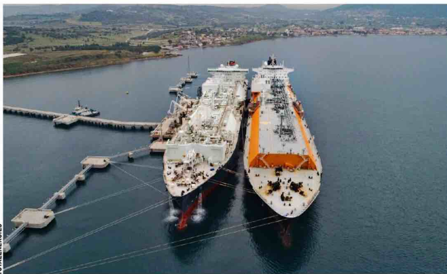
Le gaz voyage sous forme liquide dans les méthaniers. Une fois arrivé à bon port, il reprend sa forme gazeuse dans une unité flottante. Le Havre accueillera un bâtiment de ce type en 2023.
