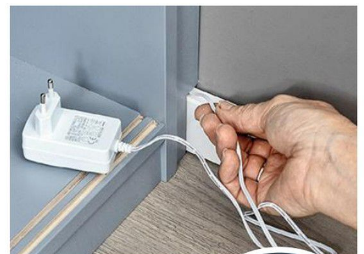
18 Branchez l'alimentation sur le transformateur, puis faites descendre le câble derrière le fileur et sur la plinthe. Branchez la prise et testez l'éclairage avec la télécommande.
