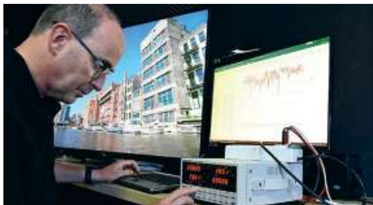
Des mesures de consommation électrique (à gauche) sont réalisées sur les téléviseurs en veille et en fonctionnement 4K HDR. La photo de droite illustre un des réglages préparatoires au jury de vision qui complète
