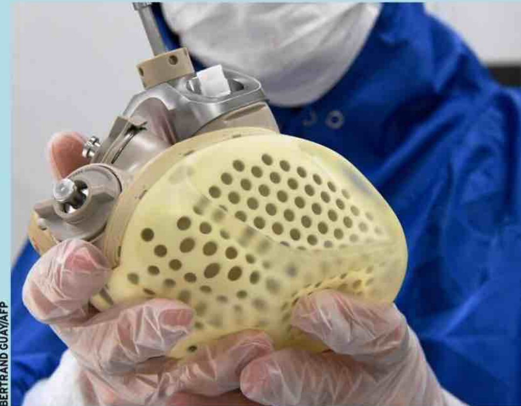
Le cœur Carmat, qui pèse 900 grammes, est composé de tissus animaux traités chimiquement afin d'éviter le rejet.
