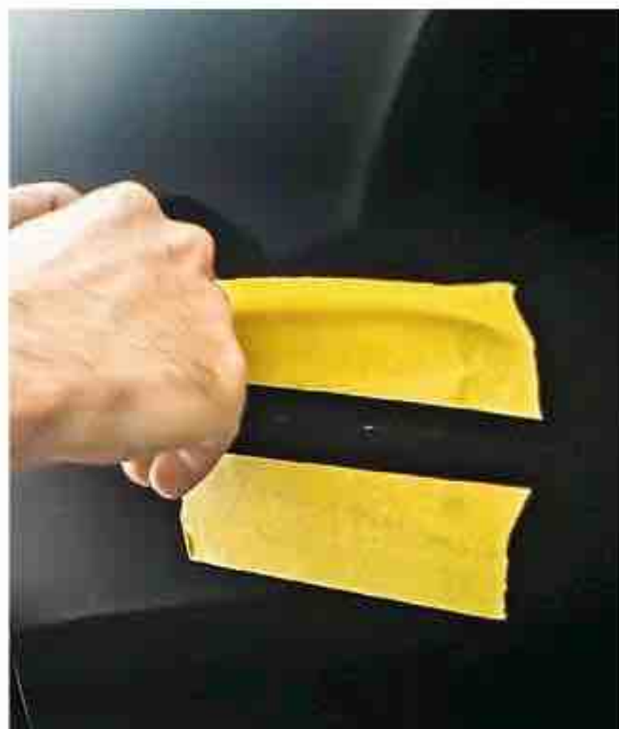
1 Après avoir lavé et séché la carrosserie, encadrez la rayure avec deux bandes d'adhésif de carrossier espacées de quelques centimètres.
