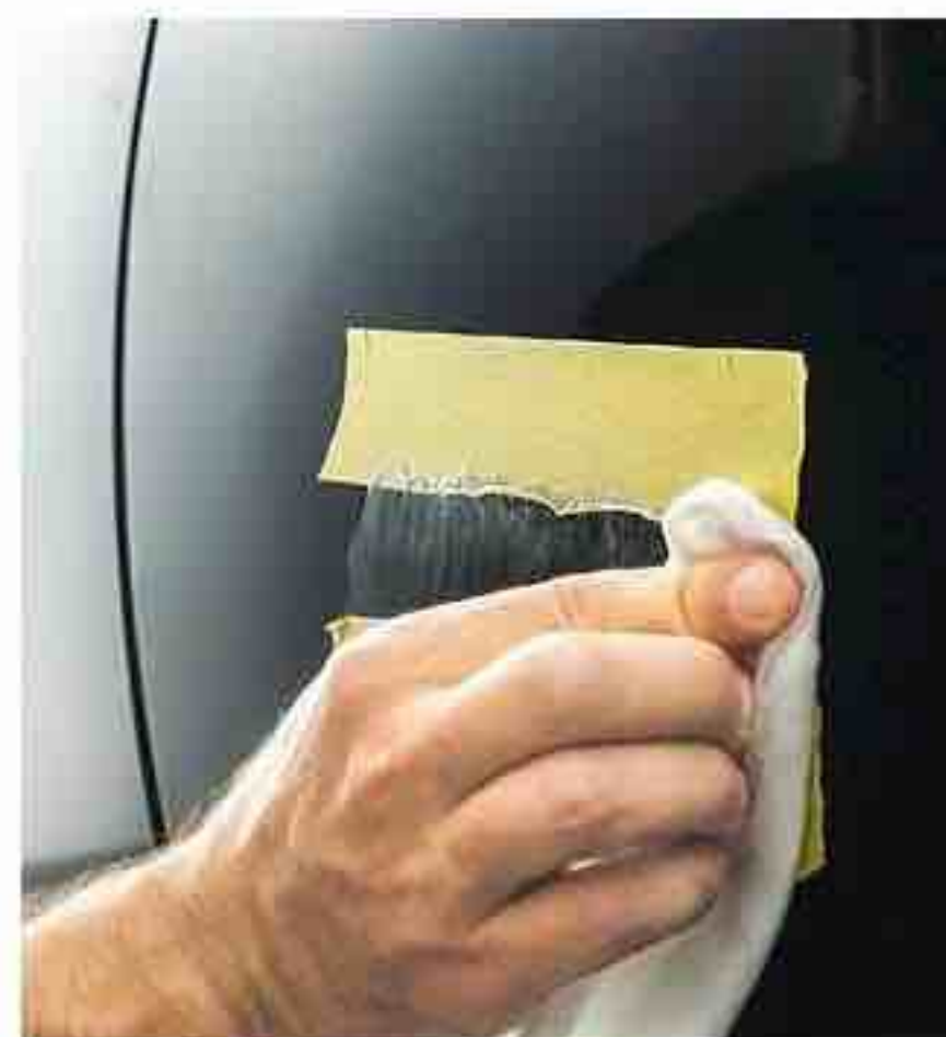
6 Enlevez immédiatement les résidus de pâte de polissage avec un chiffon humide, pour nettoyer la surface.
