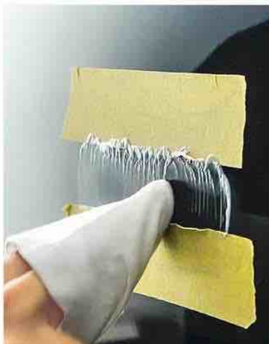
5 Déposez un peu de pâte de polissage entre les deux bandes d'adhésif et polissez au chiffon de coton, transversalement à la rayure, une à deux minutes durant.
