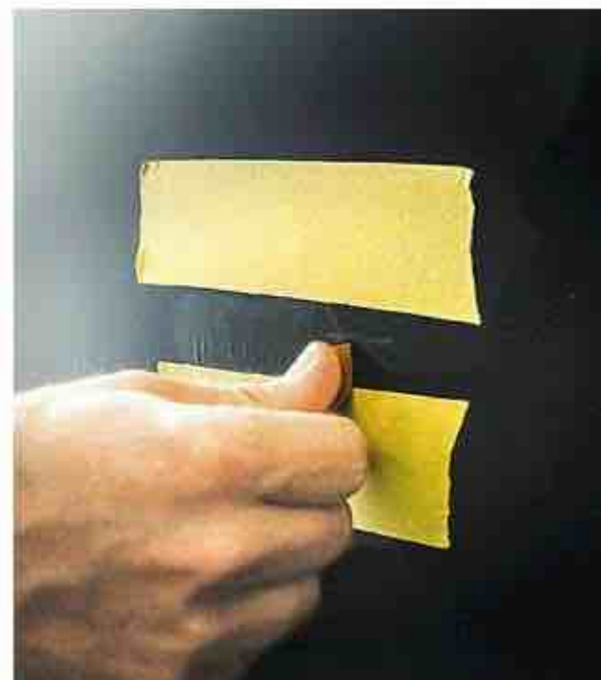
3 Poncez la zone de la rayure avec l'abrasif pendant une quinzaine de secondes maxi. Il s'agit uniquement de déglacer la peinture.
