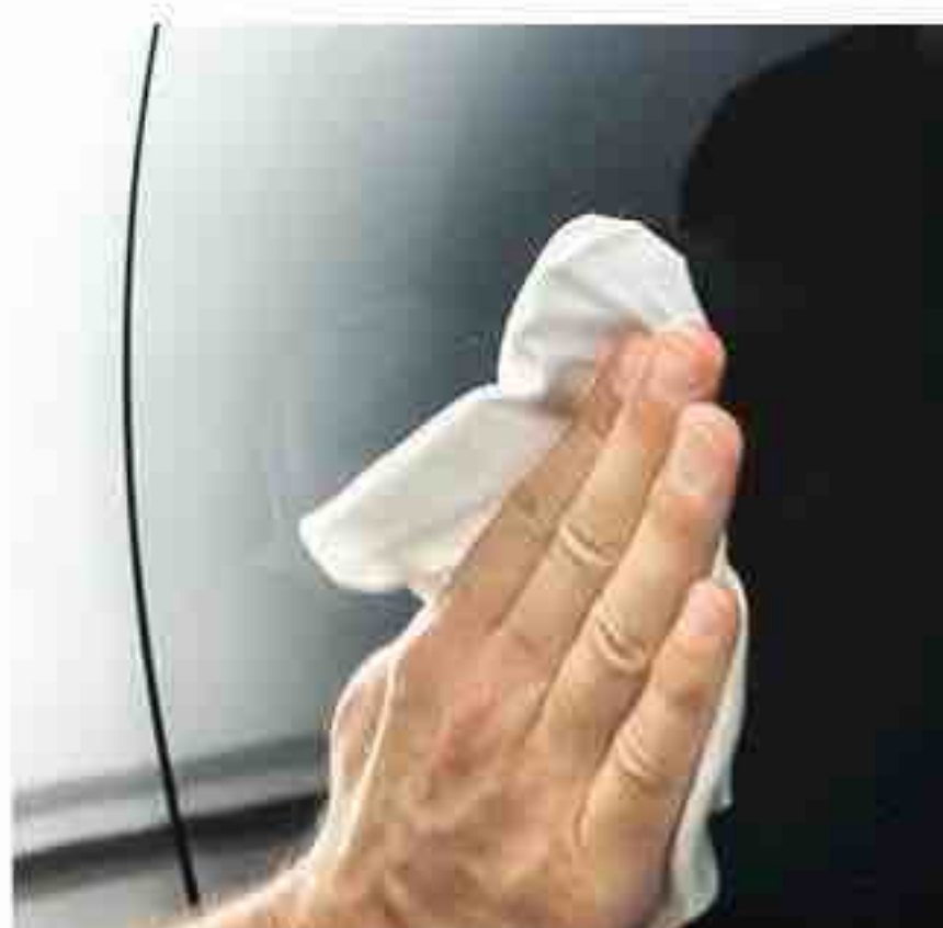
8 Il reste à éliminer les résidus de pâte de polissage pouvant subsister à la surface de la tôle, puis à lustrer avec la pâte de finition.
