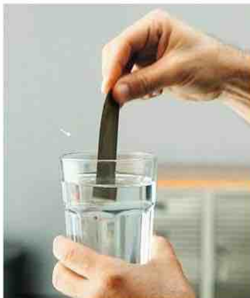
2 Humidifiez la toile émeri fournie en la trempant dans un verre rempli d'eau. C'est indispensable pour bien l'utiliser.
