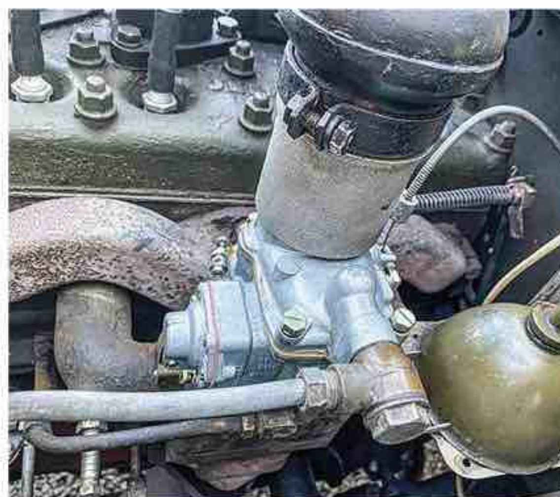
L'entretien du véhicule ne nécessite pas toujours de remplacer les pièces. Mais, parfois, il faut les démonter, comme ces durites à eau du système de refroidissement, pour bien les nettoyer.
