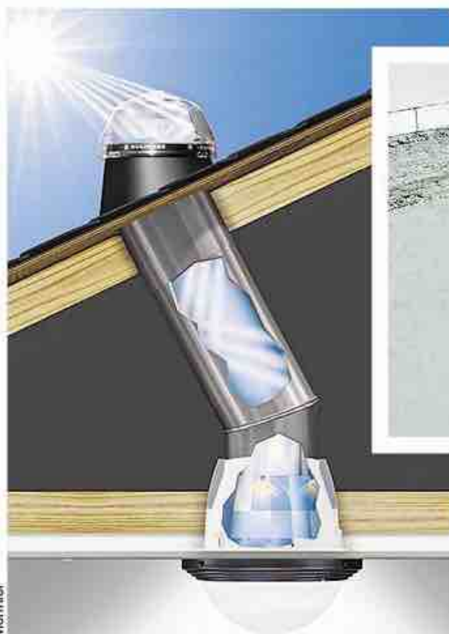
4 La lumière du jour pénètre par un dôme vitré, fixé en toiture. Elle est transportée par un tube réfléchissant qui traverse le comble jusqu'à un ou plusieurs diffuseurs, ronds ou carrés, posés au plafond de l'espace aveugle. C'est le principe du puits de lumière, dont le coefficient de réflexion atteint 99,7 %.
