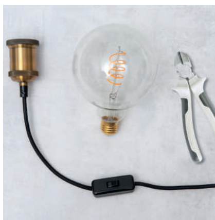
7 Montez la douille à une extrémité du câble et une fiche à l'opposé.
