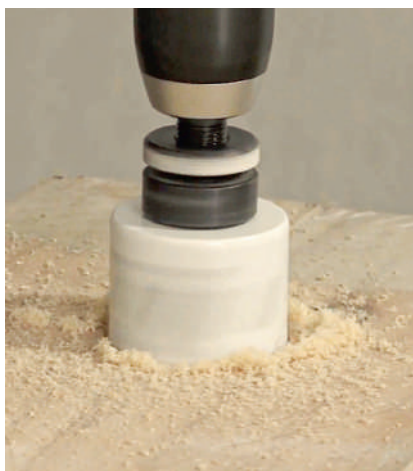
2 Mesurez le diamètre de la douille au pied à coulisse. Puis percez l'orifice avec une scie cloche de même diamètre montée sur perceuse.
