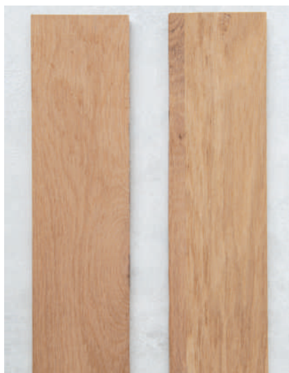
1 Une planche rabotée de 25 cm de largeur, sciée en deux dans la longueur, permet d'obtenir la tablette et son dossier.
