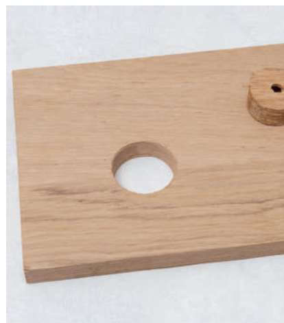
3 Guidée par un foret de centrage, la scie cloche permet de réaliser de grands perçages avec la précision requise.
