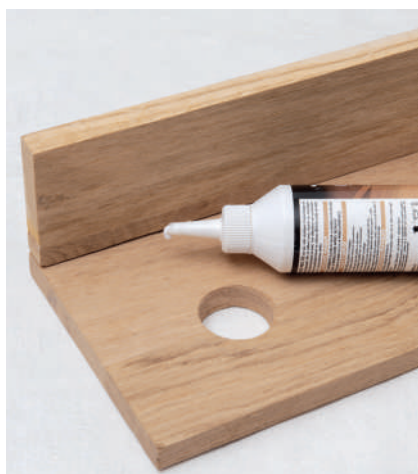
4 Assemblez le dossier à l'arrière de la tablette par collage face contre chant. Renforcez la liaison avec quelques pointes tête homme ou vis enfoncées par le dessous.
