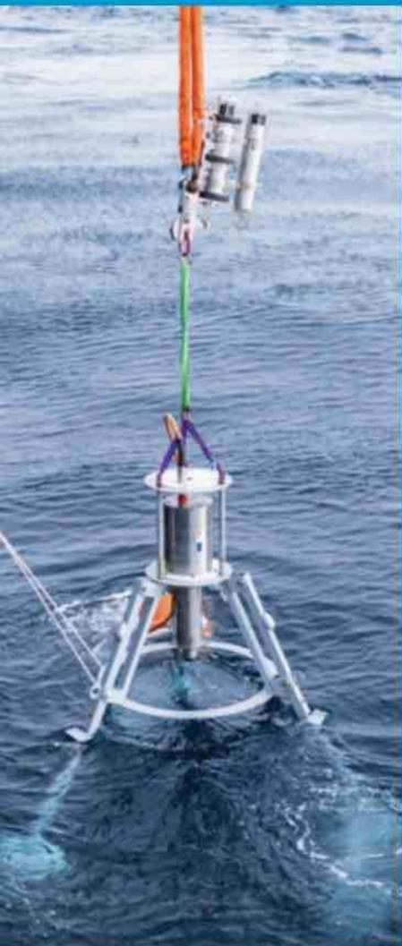
Déploiement du spectromètre gamma sur son trépied
