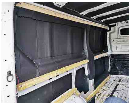
Des tasseaux sont vissés à l'intérieur du van pour y fixer les protections latérales. Une mousse isolante de 19 mm est posée sur chaque centimètre carré accessible des parois, plafond inclus. « Elle comprend un adhésif à coller sur la carrosserie. Elle va isoler tout en évitant la condensation et la rouille », explique notre lecteur.
