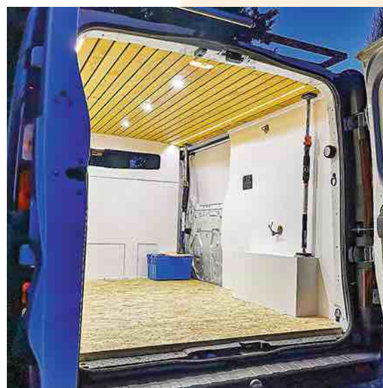
Trois spots de 12 V sont posés en enfilade au milieu du plafond. L'intérieur a été repeint en blanc et des bandeaux LEDS intégrés de chaque côté.
