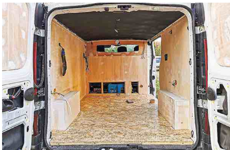
Un plancher en OSB est vissé directement sur les tasseaux. Là aussi, des inserts ont été intégrés dans le plancher afin de stabiliser les meubles et le pied de table.
