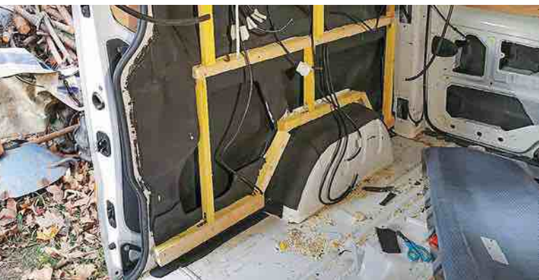
L'installation électrique est constituée de câbles souples, car ils supportent mieux les vibrations. « J'ai soumis mes schémas sur des groupes Facebook et ajusté mes calculs de puissance en fonction des retours. Je voulais être en autonomie totale et ne pas avoir à me brancher sur secteur dans un camping. » Au total, le van compte six ports USB pour charger les différents appareils.
