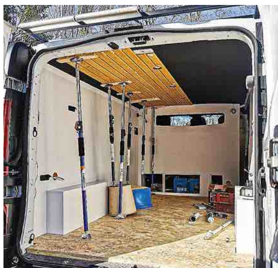
« J'ai peint le plafond en noir mat et posé des lattes recouvertes d'une finition pour protéger et conserver un aspect bois naturel. Cette étape fastidieuse m'a pris une semaine, car j'ai dû créer des gabarits, placer des étais et attendre le séchage des différentes lattes. »
