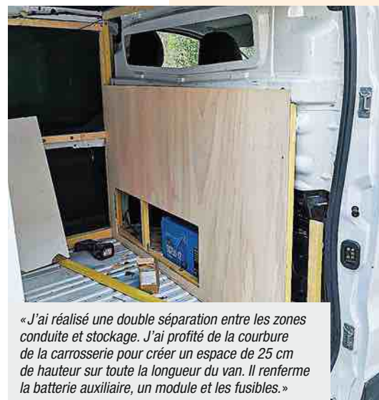
Des tasseaux sont vissés à l'intérieur du van pour y fixer les protections latérales. Une mousse isolante de 19 mm est posée sur chaque centimètre carré accessible des parois, plafond inclus. « Elle comprend un adhésif à coller sur la carrosserie. Elle va isoler tout en évitant la condensation et la rouille », explique notre lecteur.
