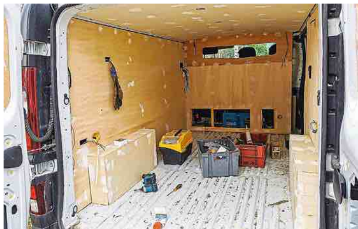
« J'ai fixé les panneaux de contreplaqué sur les tasseaux et bouché les têtes de vis avec une pâte à bois. Par anticipation, j'ai posé des inserts filetés métalliques dans les parois, là où seront intégrés les meubles et les modules. »
