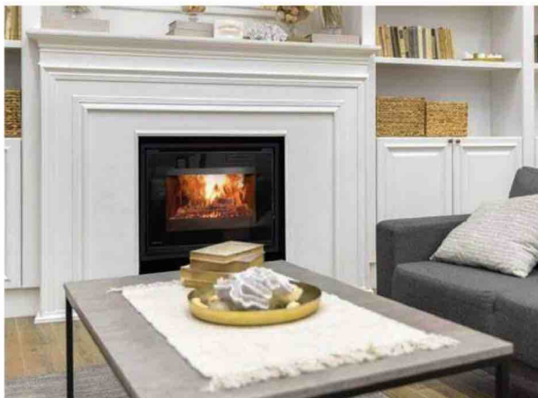
ALPHA 80-60 est un insert en acier avec son intérieur en fonte. Sa puissance est de 8 kW. Il est doté de quatre ventilateurs et d'un carter de convection et peut être canalisable et renvoyer l'air dans d'autres pièces de la maison. TURBO FONTE
