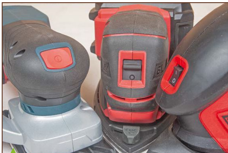
Les interrupteurs de Bosch, Skil et Einhell, quoique de conception différente, sont placés sur le nez des machines, très accessibles. Notez également sur cette photo le levier « clic » permettant le déblocage/reverrouillage de l'avant de la semelle de Skil.
