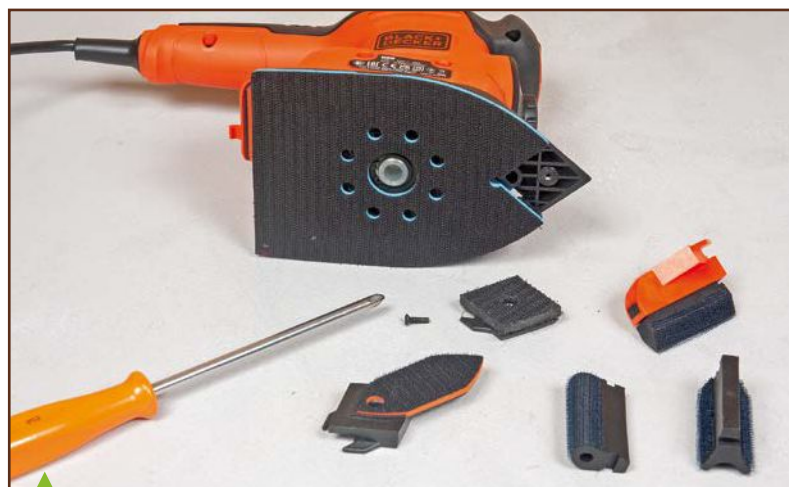
La Black+Decker possède aussi tout un lot de petits patins additionnels qui remplacent l'avant de la semelle. Le petit patin plat possède sa propre semelle, les patins de forme ont un support commun.
