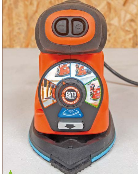
L'interrupteur à deux poussoirs de Black+Decker est moins maniable que les précédents. Le bouton rotatif « autoselect » de la vitesse de rotation, est à quatre positions, mais ne commande en fait que deux vitesses. Notez en bas de cette photo le poussoir permettant de débloquer le bloc semelle pour passer de ponceuse delta à ponceuse roto-orbitale.
