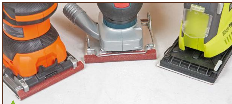
La possibilité de remplacer le patin triangulaire par un patin carré est encore plus intéressante si le patin est équipé de pinces permettant d'utiliser des abrasifs ordinaires (sachant que l'aspiration sera alors inefficace). De gauche à droite : AEG, Bosch et Ryobi.
