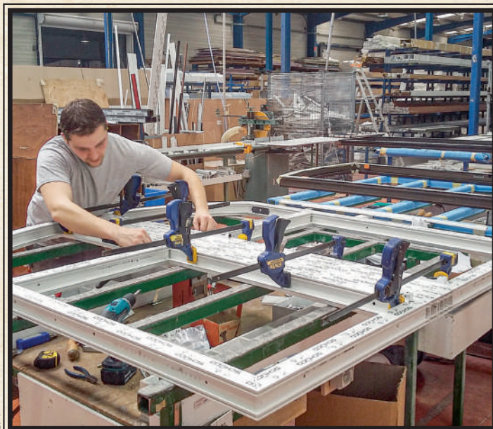
Le PVC permet de fabriquer des menuiseries isolantes d'un bon rapport qualité/prix, comme cette fenêtre cintrée à double battant. La recyclabilité du matériau de base est un argument non négligeable au regard de son origine pétrolière.
