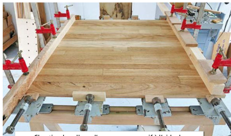
Chantier de collage d'un panneau massif à l'aide de mes dormants lourds. Notez que les cornières permettent de bonnes surfaces d'appui pour les serre-joints additionnels.
