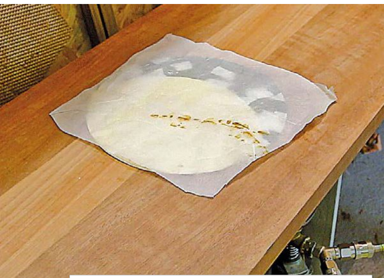
On isole le collage du tissu poumon avec du papier sulfurisé.
