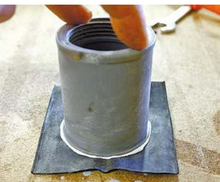
Assembler le manchon et la chambre à air avec du joint PU.
