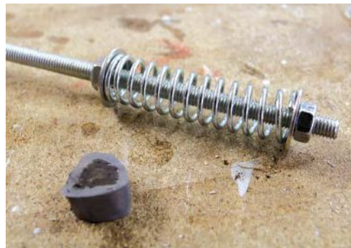
Coller deux rondelles sur le ressort, à l'aide de résine époxy.
