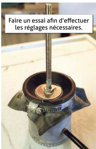
Tendre la chambre sur le manchon en centrant la vis.
