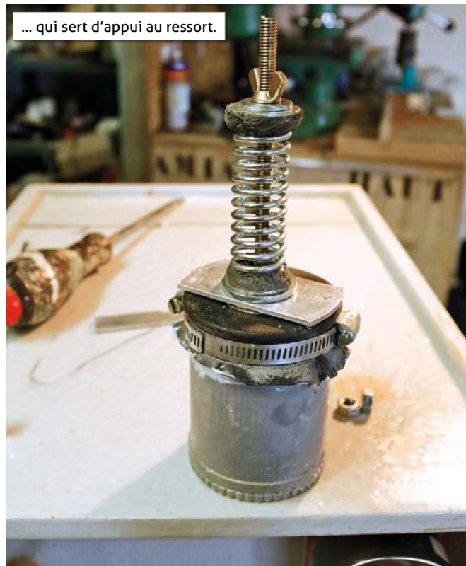
Tendre la chambre sur le manchon en centrant la vis.
