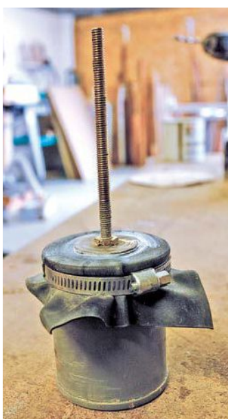
Tendre la chambre sur le manchon en centrant la vis.
