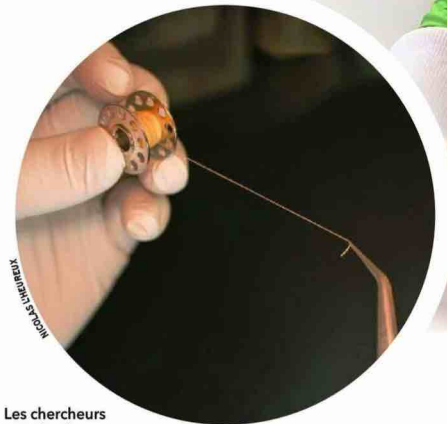
Les chercheurs ont réussi à concevoir des fils à partir de matrice extracellulaire, un matériau riche en collagène produit par des cellules de peau humaine.
