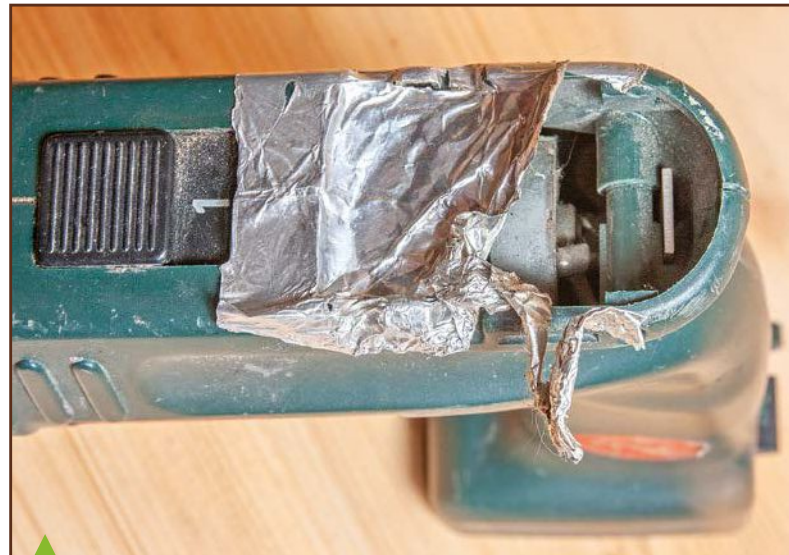
Machine amenée en l'état au repair café : est-ce bien sérieux de réparer ainsi un carter, avec de l'aluminium, donc un matériau conducteur ? On voit même les cosses du moteur directement en dessous ! S'agissant d'une perceuse sans fil, au moins n'y a-t-il pas de risque d'électrocution...
