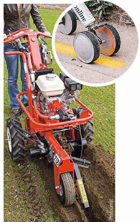
La trancheuse de sol (disponible en location) creuse son sillon en marche arrière (tranchée plus évasée en haut). Avant de démarrer, il faut tracer une ligne de guidage rectiligne à l'aide d'une canne de marquage et d'un aérosol.
