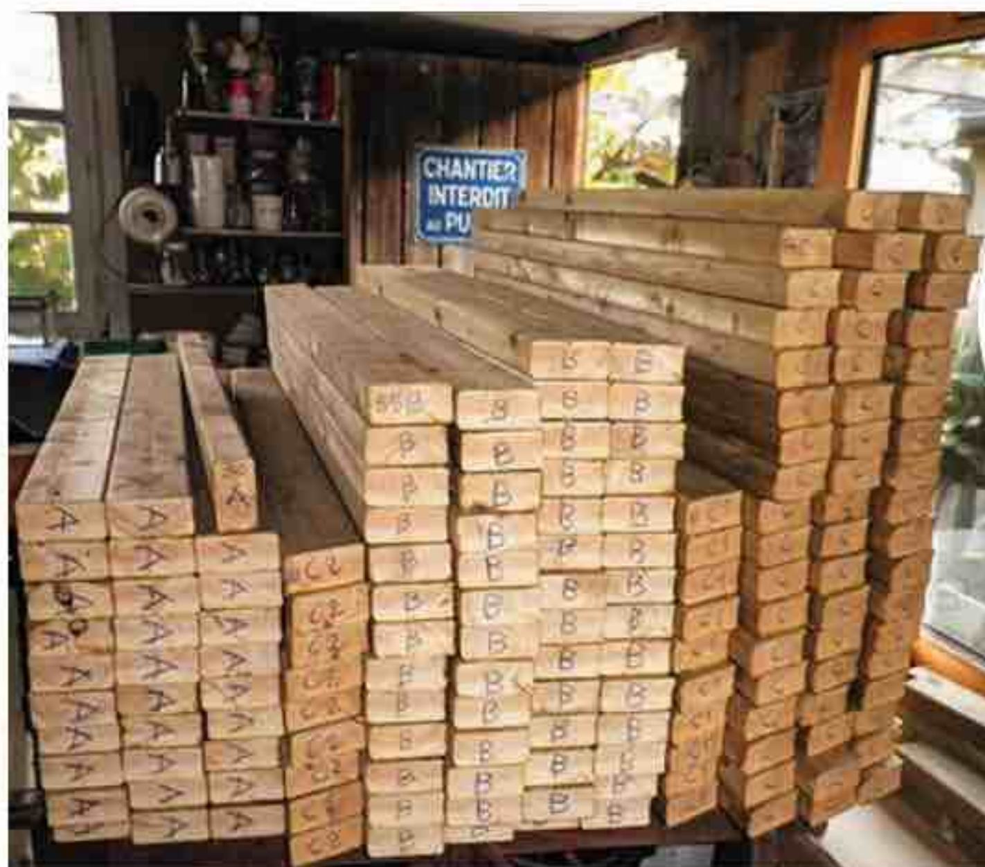
Une fois les montants débités, ils sont répertoriés suivant les indications de l'épure et stockés. Les chiffres inscrits indiquent le nombre de chacune des quatre longueurs prédéfinies.
