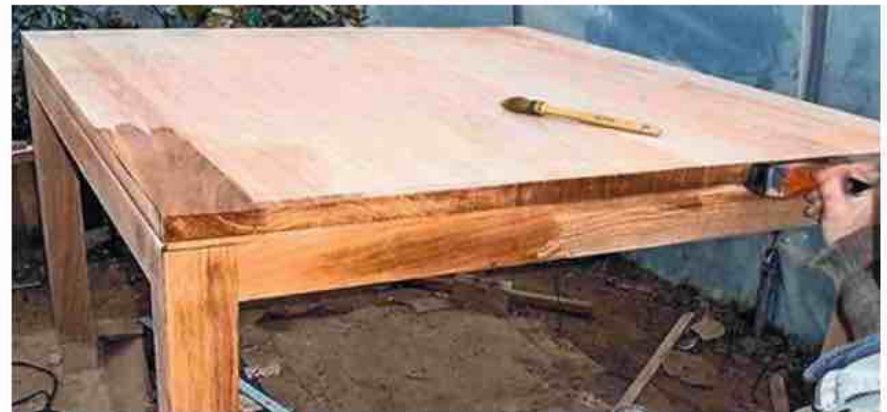
Le plateau est fixé sur son piétement par quelques vis. Le meuble est ensuite protégé par un vernis.
