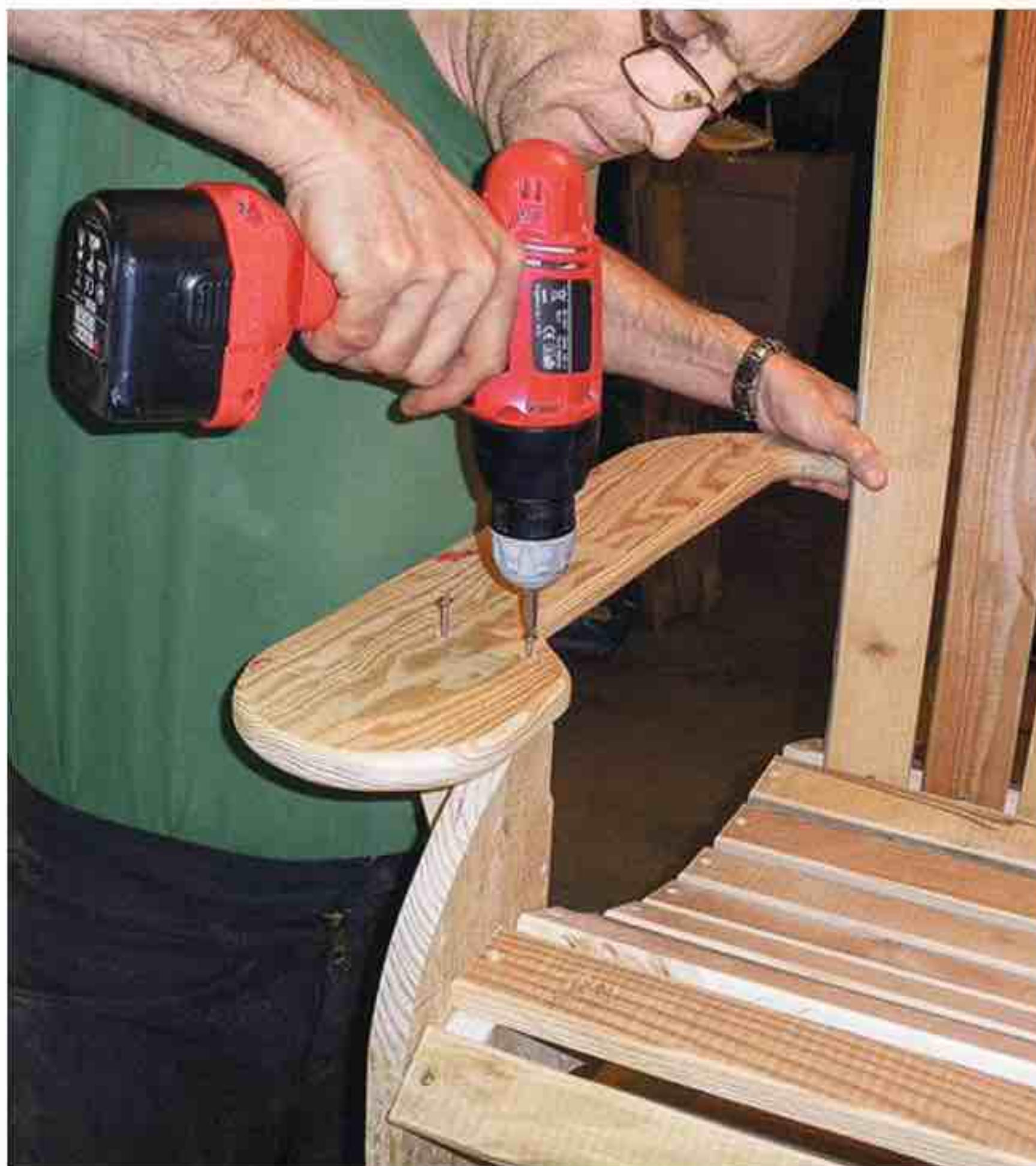
13 Vissez les supports d'accoudoirs contre les pieds avant. Le dessus de ces supports triangulaires affleure le sommet arrondi des pieds. Fixez-y les pièces servant d'accoudoirs à l'aide de trois vis (4 x 50 mm).
