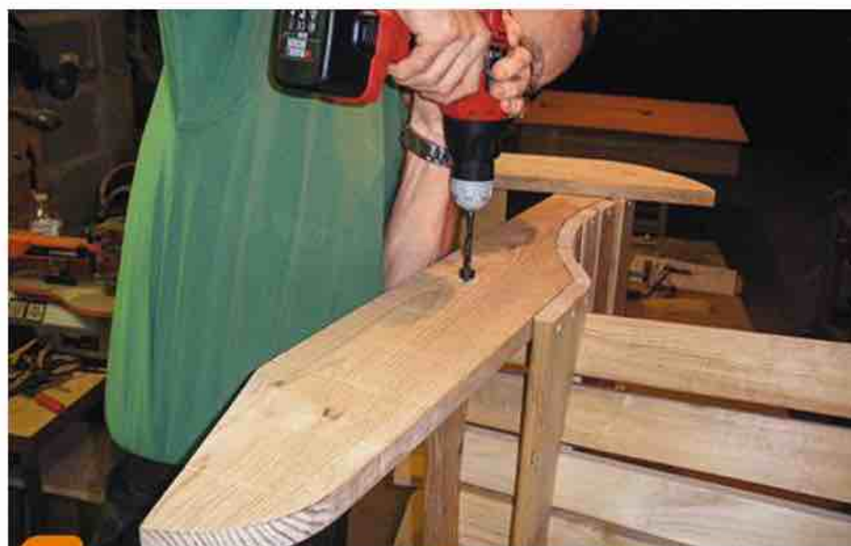
12 Percez, vissez les côtés du piètement contre la traverse basse du dossier (vis de 4 x 50 mm) en calant les extrémités de la traverse. Placez trois vis en bout.
