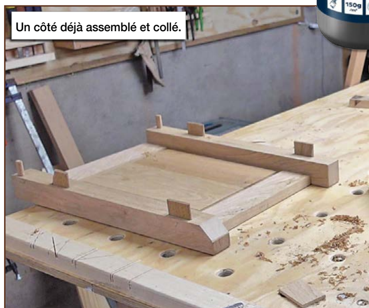
Des entailles dans les angles sont nécessaires pour faire entrer le panneau.
