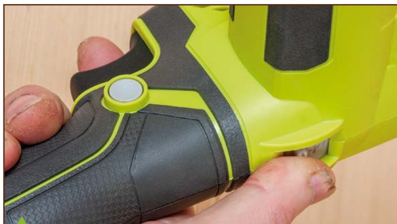
Toutes les machines sont dotées d'un variateur, celui de la Ryobi, disposé longitudinalement et avec une course peu importante, tombe vraiment bien sous les doigts sans bouger la main.
