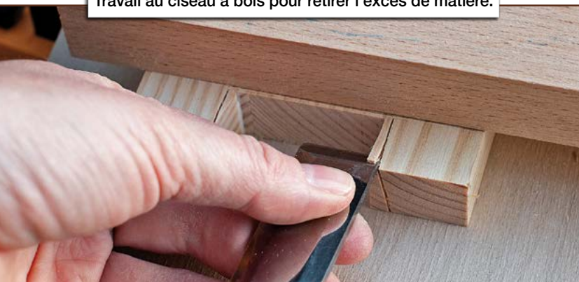
Travail au ciseau à bois pour retirer l'excès de matière.
