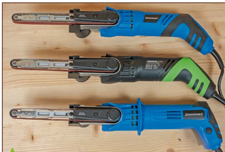
L'ancien modèle Silverline (en haut) est strictement identique à la Constructor. La nouvelle Silverline (en bas) ne change que par des détails cosmétiques : remplacement de l'interrupteur par une gâchette avec poussoir de blocage et ajout d'une colerette entre la poignée et le bras qui n'apporte pas grand-chose.
