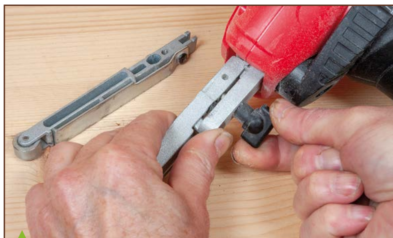
Sur les trois machines dont le bras se démonte, il est important de maintenir le bras plaqué contre son support pendant que l'on dévisse la molette, sinon le ressort fait partir la vis en travers et on risque d'abîmer le filetage. C'est juste un coup de main à prendre, mais les notices ne l'indiquent pas.
