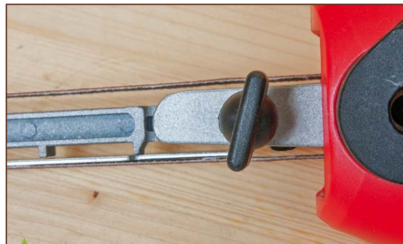
Lorsque la molette de réglage de la Wiltec est placée perpendiculairement au bras, elle dépasse au-dessus et en dessous, mieux vaudra tomber sur un réglage de bande où elle s'approche de l'horizontale si l'on doit utiliser toute la longueur du bras. Autre reproche : lorsque le bras est rétracté, la molette se trouve juste contre le carter de la machine, ce qui la rend désagréable à manipuler.
