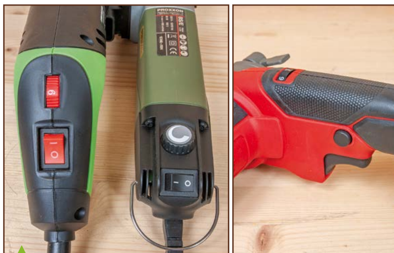
La Constructor et la Proxxon sont les deux seules machines dotées d'un interrupteur à bascule, toutes les autres sont dotées d'une gâchette avec poussoir servant de sécurité antidémarrage (Wiltec seulement) ou plus généralement au verrouillage en marche.
