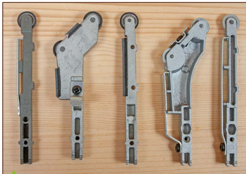
Les bras additionnels (de gauche à droite) : Einhell droit 9 mm, B+D coudé 13 mm, B+D droit 6 mm, Wiltec coudé 13 mm, Wiltec droit 6 mm. À noter : visible sur le bras coudé B+D sous la vis cruciforme noire, le crochet en tôle spécifique à ce bras.
