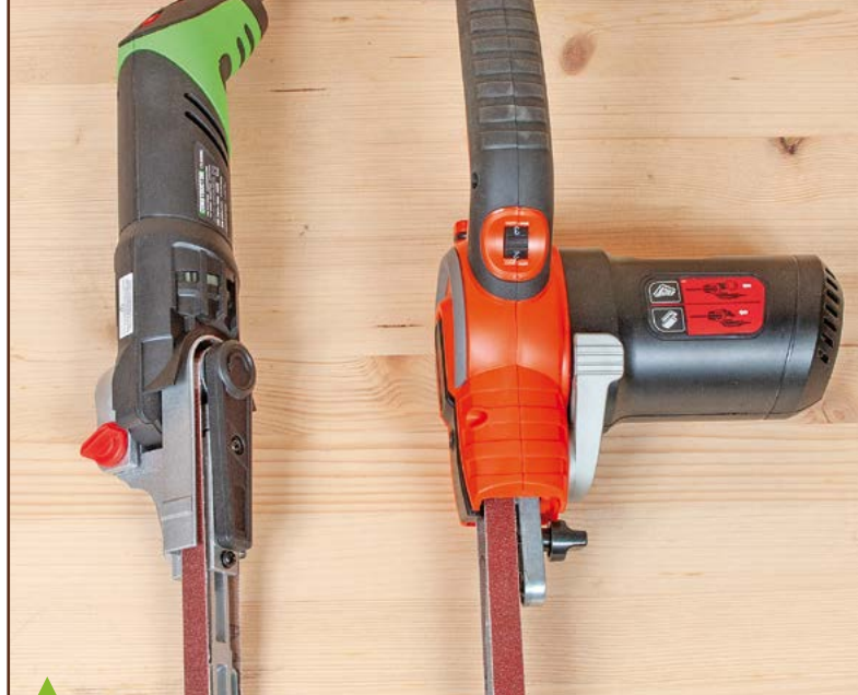
Deux conceptions sensiblement différentes : moteur longitudinal peu encombrant, mais imposant une transmission par renvoi d'angle ; moteur transversal, plus simple, en entraînement direct, mais déséquilibrant la machine vers la gauche.
