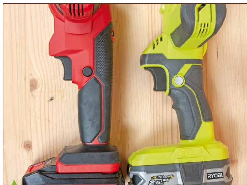
Dans le plan vertical, exception faite de la Ryobi, toutes les machines ont le bras dans l'axe de la poignée ou dans un axe parallèle. La poignée inclinée de la Ryobi n'est pas très agréable, car elle oblige à compenser l'inclinaison en cassant le poignet si l'on veut garder le bras horizontal (sauf bien sûr en travaillant au ras du sol).
