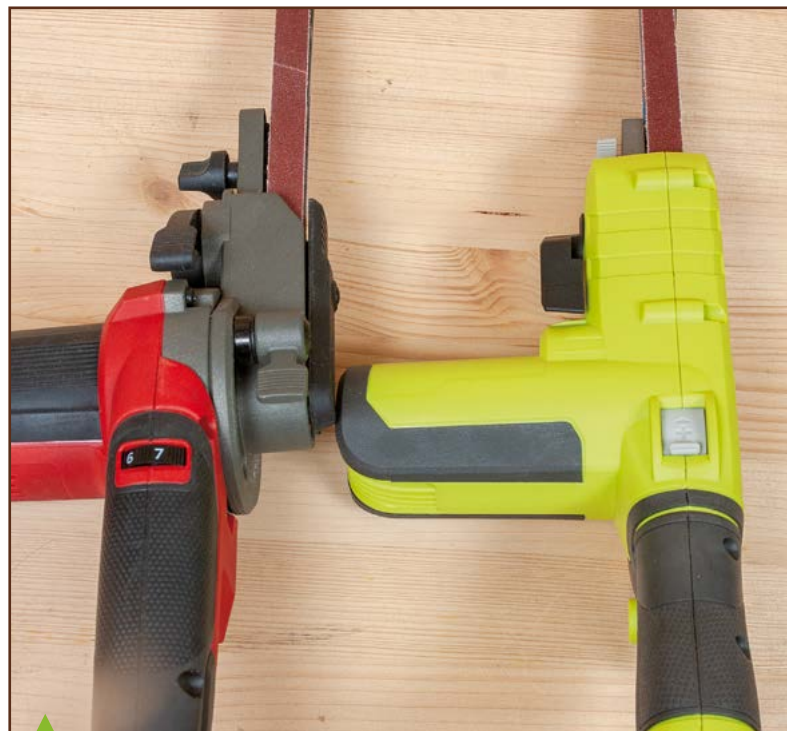
Le moteur latéral crée un déséquilibre très significatif de la machine. Le décalage du bras vers la droite permet à Einhell de réduire très significativement ce balourd, ce que ne fait pas Ryobi, et du coup cette machine est la seule à avoir la bande dans le strict prolongement de la poignée dans le plan horizontal.
