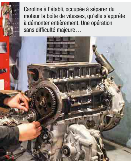
Mais il faut de la méthode et un outillage adapté pour déboulonner les différents éléments de l'embrayage (cylindre récepteur, cloche...), desserrer les vis qui maintiennent la boîte au moteur, etc.
