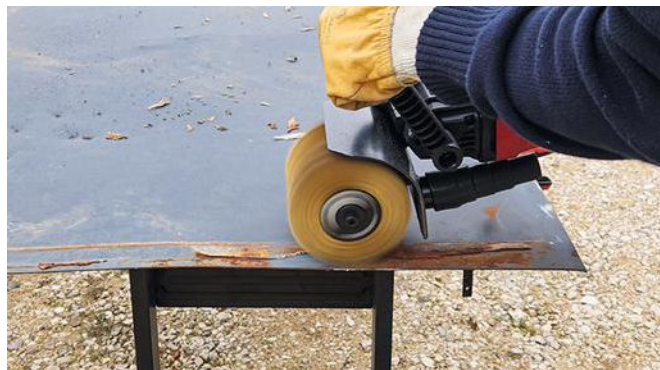
Cette tôle d'acier galvanisé portait des plots de mastics-colle sur son pourtour et des plaques de rouilles sur sa périphérie. Il n'aura fallu que quelques minutes pour que l'outil l'en débarrasse.
