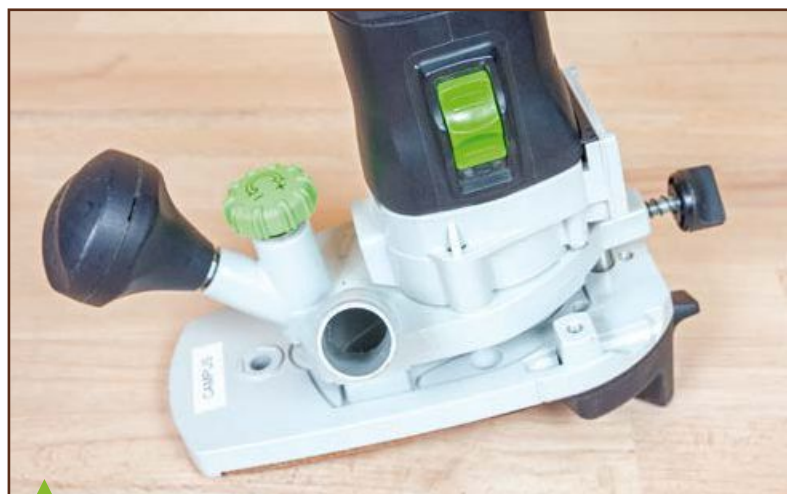
La base de la Festool est beaucoup plus large que celle des autres machines, et l'affleureuse est ainsi beaucoup plus stable. La course de réglage, à l'aide de la molette verte, est assez réduite et il faudra donc également jouer avec l'enfoncement plus ou moins grand de la queue de fraise dans l'arbre.
