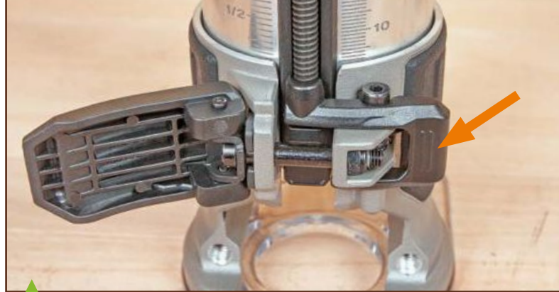
Pour éviter de devoir si nécessaire tourner la vis sur toute la course, la Ryobi est dotée d'un poussoir placé à droite derrière la bride qui permet de débrayer la vis ; sur l'AEG il suffit de décaler légèrement le moteur dans la base pour obtenir le même résultat.
