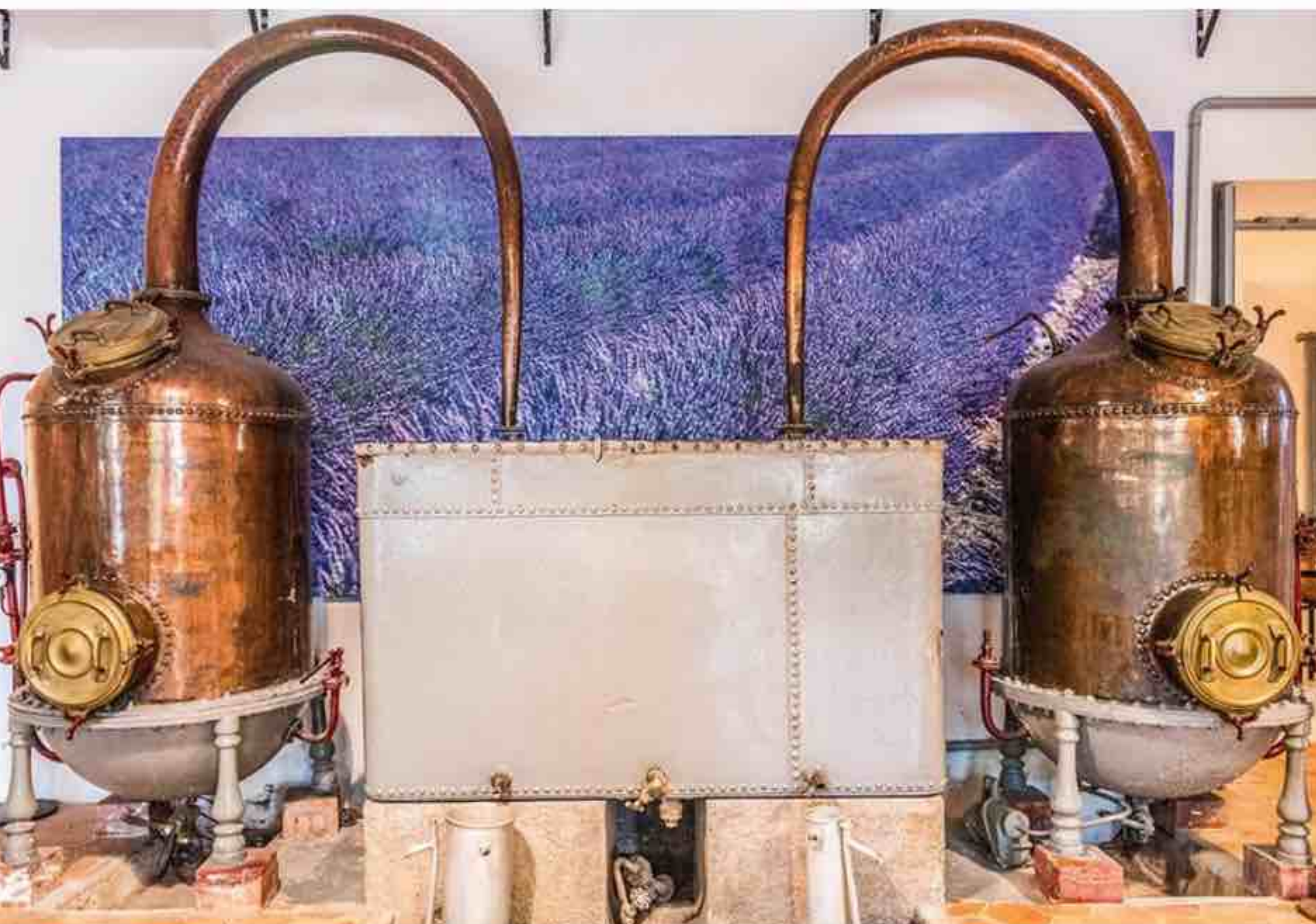
Les anciennes cuves en cuivre de la parfumerie Fragonard témoignent du savoir-faire ancestral de la distillation à la vapeur d'eau.
