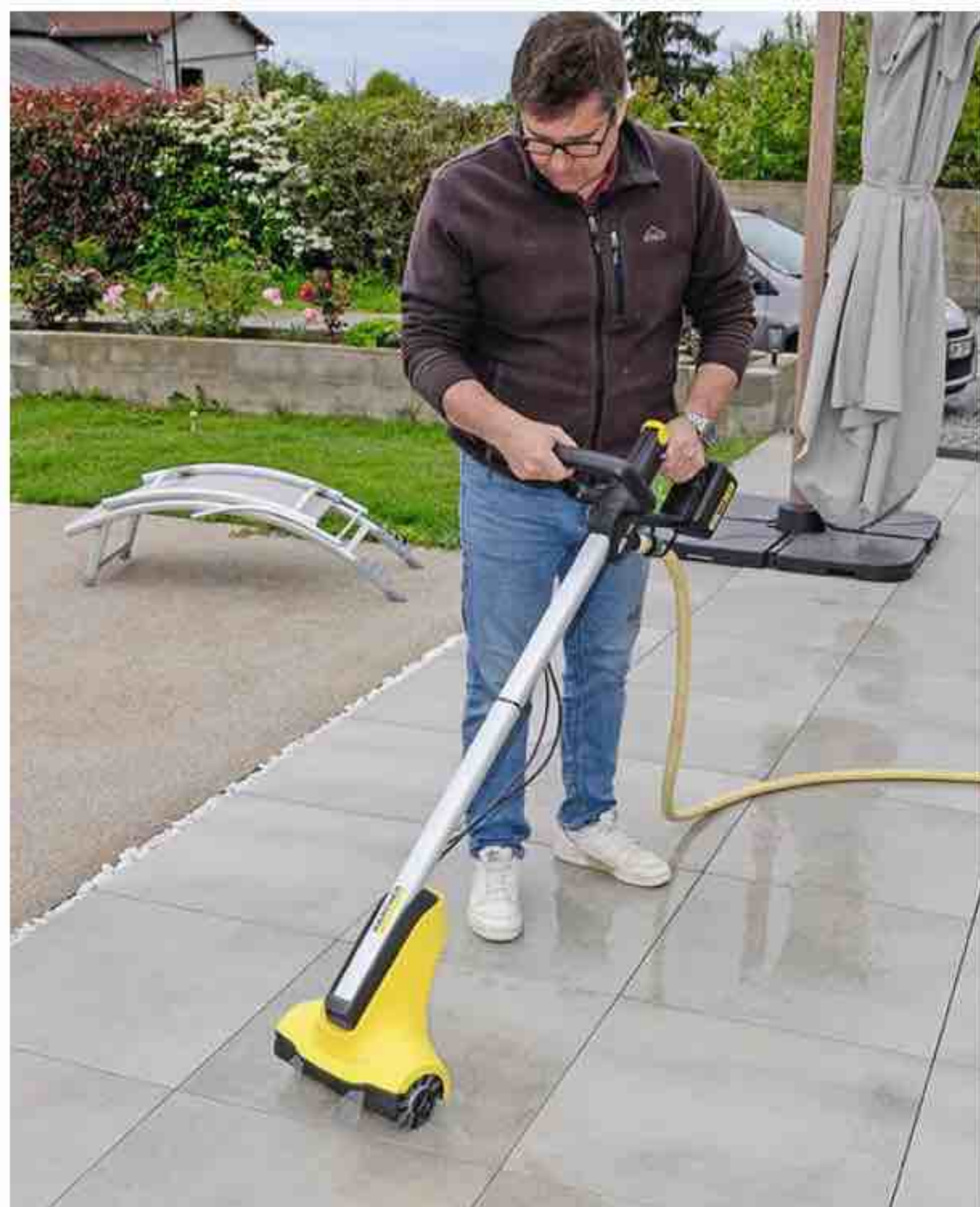
Le système de nettoyage des Einhell et Kärcher est constitué de deux brosses. Cette configuration aide à avoir une bonne largeur de travail.
