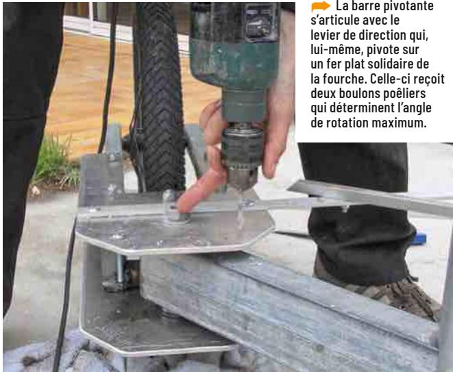
► La barre pivotante s'articule avec le levier de direction qui, lui-même, pivote sur un fer plat solidaire de la fourche. Celle-ci reçoit deux boulons poêliers qui déterminent l'angle de rotation maximum.
