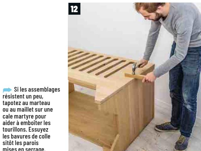
▶ Si les assemblages résistent un peu, tapotez au marteau ou au maillet sur une cale martyre pour aider à emboîter les tourillons. Essuyez les bavures de colle si tôt les parois mises en serrage.
