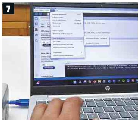
▶ Téléchargez le logiciel Arduino IDE sur le site [www.arduino.cc](http://www.arduino.cc) à la rubrique « Products ». Installez-le et lancez-le. Déclarez la carte dans « Outils/Carte/Gestionnaire de carte ». Sélectionnez « Une autre carte et un autre port », choisissez « Arduino Uno », « Port Com3 » (ou 2, ou 5).
