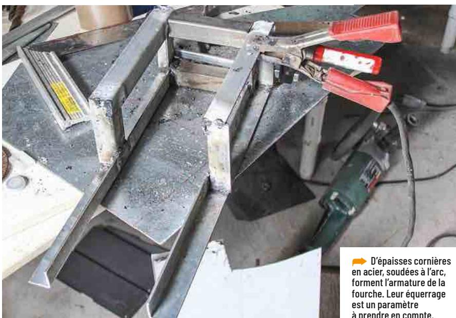
► D'épaisses cornières en acier, soudées à l'arc, forment l'armature de la fourche. Leur équerrage est un paramètre à prendre en compte.
