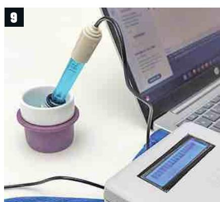
▶ Branchez la sonde à l'entrée correspondante sur le boîtier. Téléchargez le code (utilisez le QRCode ci-contre) et double-cliquez sur le fichier.ino. Dans l'Arduino IDE, cliquez sur « Vérifiez » le code (l'icône Virgule), puis « Téléversez » (la flèche orientée vers la droite) pour mettre le code dans la mémoire de la carte.
