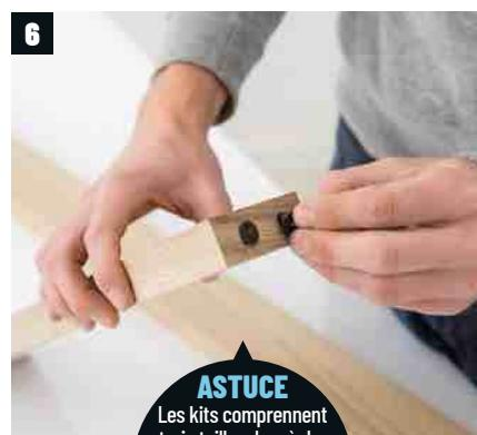
Enfoncez dans les perçages des pions de centrage (ou marqueurs) de grosseur adaptée à celle des tourillons mis en œuvre. Sinon, servez-vous d'un guide de perçage à main levée : le marché du bricolage en propose plusieurs modèles (voir encadré).
