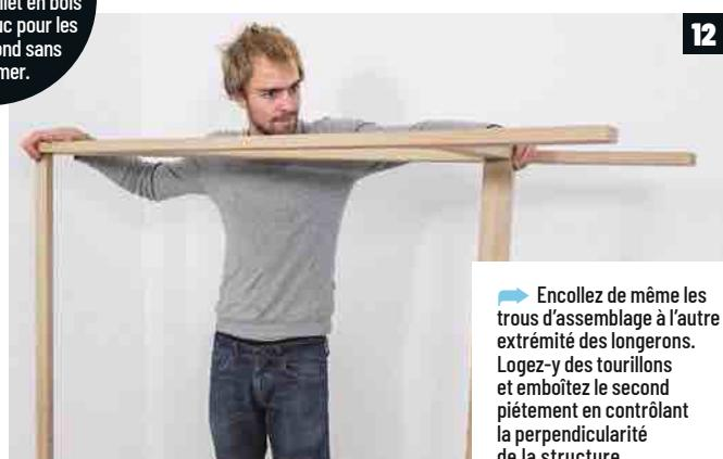
→ Enclez de même les trous d'assemblage à l'autre extrémité des longerons. Logez-y des tourillons et emboîtez le second piétement en contrôlant la perpendicularité de la structure.
