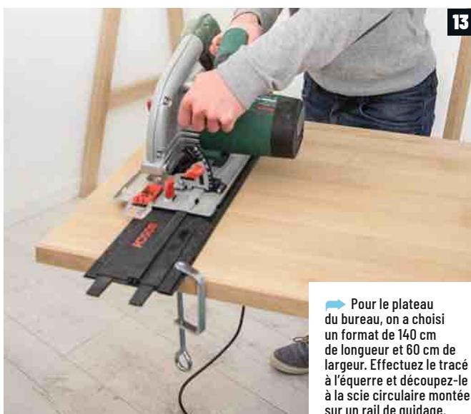
→ Pour le plateau du bureau, on a choisi un format de 140 cm de longueur et 60 cm de largeur. Effectuez le tracé à l'équerre et découpez-le à la scie circulaire montée sur un rail de guidage.
