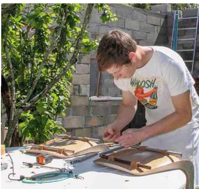
► Les premiers essais sur route révèlent quelques faiblesses. Les supports de sièges en alu, qui ont flanché, laissent la place à des tubes d'acier plus résistants. La barre de direction demande aussi à être renforcée.
