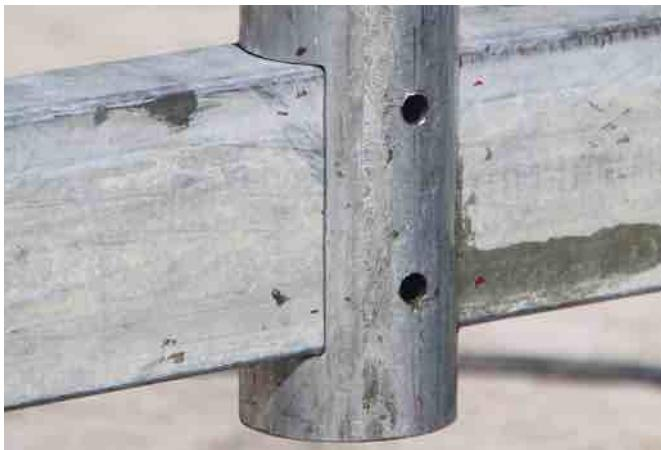
► Le pied de mât est arrêté en respectant un entraxe de 35 cm par rapport à l'extrémité du timon. Après avoir vérifié son aplomb, les deux pièces sont percées de part en part afin d'être boulonnées ensemble.
