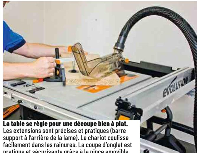
**La table se règle pour une découpe bien à plat.** Les extensions sont précises et pratiques (barre support à l'arrière de la lame). Le chariot coulisse facilement dans les rainures. La coupe d'onglet est pratique et sécurisante grâce à la pince amovible.
