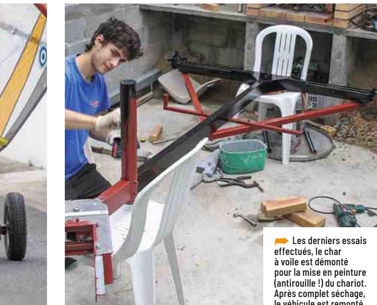
► Les derniers essais effectués, le char à voile est démonté pour la mise en peinture (antirouille !) du chariot. Après complet séchage, le véhicule est remonté.
