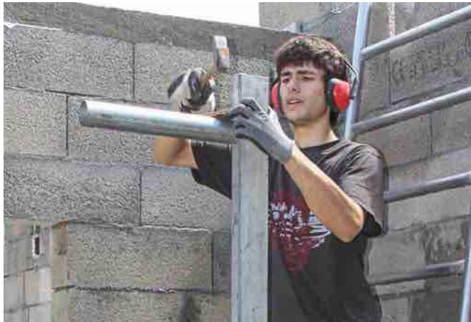
► Tracées et découpées avec une extrême précision, les encoches du pied de mât tubulaire permettent de l'engager en force sur le timon.
