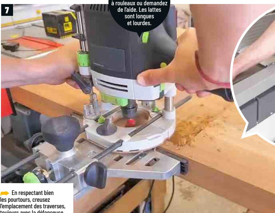
▶ En respectant bien les pourtours, creusez l'emplacement des traverses, toujours avec la défonceuse.
