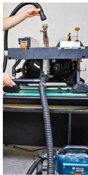
**La machine est dotée d'un double système d'aspiration** La machine est dotée d'un double système d'aspiration (par le dessus et le dessous de la lame). Les sciures et copeaux sont facilement aspirés, laissant peu de résidus sur la table.
