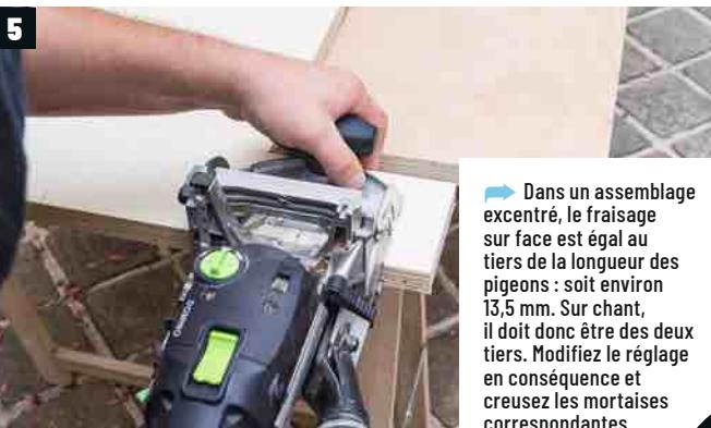
→ Dans un assemblage excentré, le fraisage sur face est égal au tiers de la longueur des pigeons : soit environ 13,5 mm. Sur chant, il doit donc être des deux tiers. Modifiez le réglage en conséquence et creusez les mortaises correspondantes.
