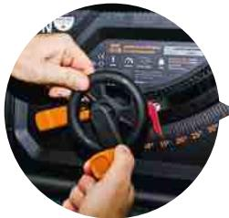
Le réglage de la hauteur de lame rapide grâce au la poignée rotative. Son inclinaison s'effectue avec le volant situé juste derrière. Tout est facilement réglable et ajustable par simple vissage.
