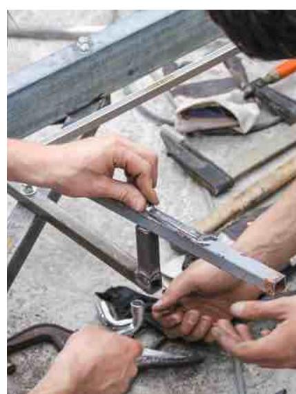
Les deux branches en cornière de la fourche sont encochées en vis à vis de manière à s'emboîter sur chaque extrémité de l'axe de la roue avant. D'autres écrous avec rondelles assurent le maintien.
