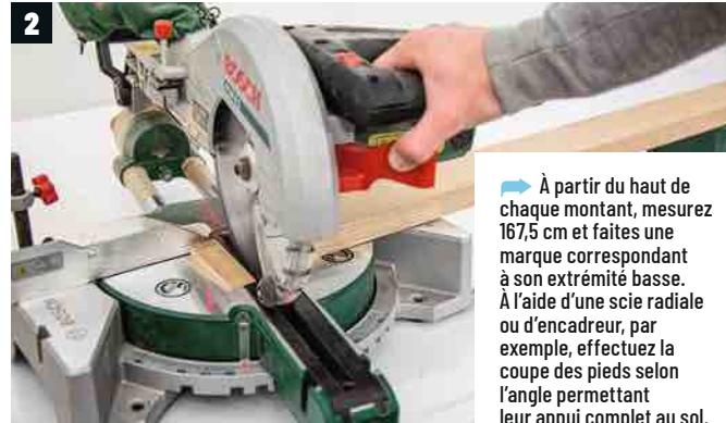
À partir du haut de chaque montant, mesurez 167,5 cm et faites une marque correspondant à son extrémité basse. À l'aide d'une scie radiale ou d'encadreur, par exemple, effectuez la coupe des pieds selon l'angle permettant leur appui complet au sol.
