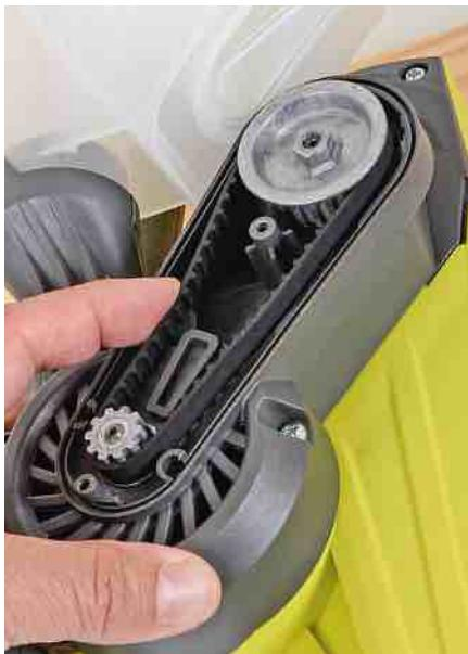
L' entraînement de la bande abrasive se fait à l'aide d'une courroie crantée. Elle doit être contrôlée régulièrement et être remplacée si besoin. Elle peut se trouver chez chaque fabricant ou sur les sites marchants sur le Web. Son accès est facilité pour un carter rapide à démonter.
