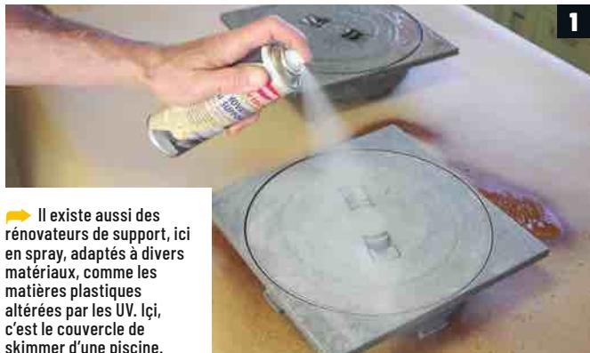
Il existe aussi des rénovateurs de support, ici en spray, adaptés à divers matériaux, comme les matières plastiques altérées par les UV. Ici, c'est le couvercle de skimmer d'une piscine.
