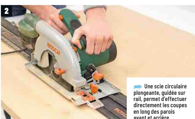
Une scie circulaire plongeante, guidée sur rail, permet d'effectuer directement les coupes en long des parois avant et arrière.
