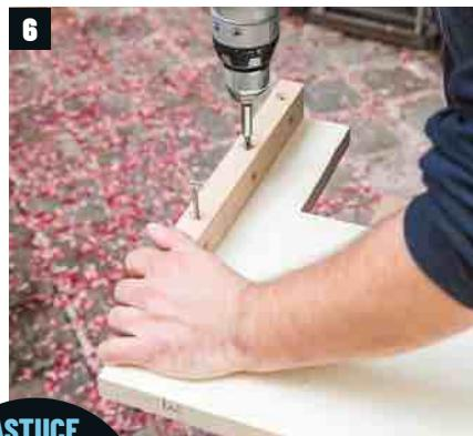
→ Le fabricant propose des ferrures « spéciales bâti de lit ». Ici, on préfère renforcer les angles du cadre avec des tasseaux de hêtre. Coupez-les à 28 cm de hauteur et vissez-les aux extrémités des deux grands côtés, en les calant sur le bas des pieds.
