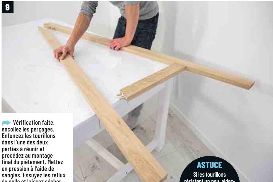
→ Vérification faite, enclez les perçages. Enfoncez les tourillons dans l'une des deux parties à réunir et procédez au montage final du piétement. Mettez en pression à l'aide de sangles. Essuyez les reflux de colle et laissez sécher.
