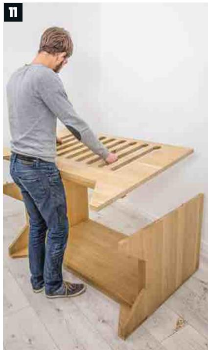
▶ Ajoutez la façade, en contrôlant l'équerrage d'ensemble. Puis mettez à sécher sous presse : grands serre-joints ou sanglage. Prenez soin d'interposer des cales pour ne marquer que le bois du lit.
