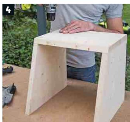
Vissez le dessus dans le plus petit chant des flancs, en veillant à maintenir les pièces perpendiculaires entre elles. Puis inversez le sens et faites de même avec le dessous.
