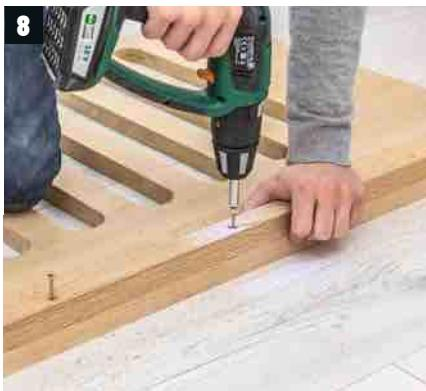
▶ Le chêne est un bois dur qui nécessite un préperçage des tasseaux (mèche hélicoïdale de Ø 3 mm). Élargissez également, à l'aide d'une fraise conique, les entrées des trous afin d'y noyer les têtes des vis.
