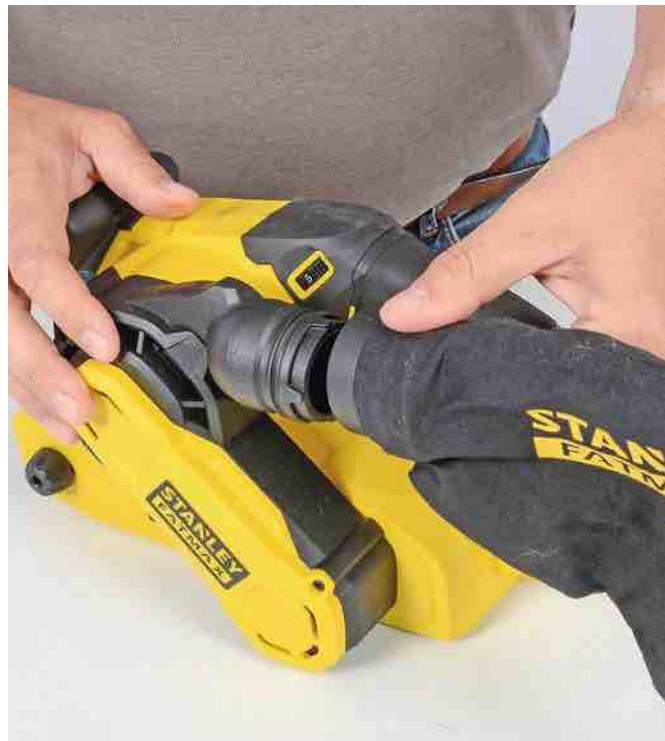
Si chaque machine essayée utilise la cartouche filtrante rigide pour la collecte des poussières, Stanley reste fidèle au sac en tissu. Équipé d'une fermeture, il est facile à vider, reste efficace et simple à mettre en place.
