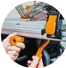
Avec son double système de coulisse à crémaillère, la table s'ajuste avec précision. Le système de verrouillage à levier est très accessible. Le rail de guidage se verrouille suivant deux positions.
