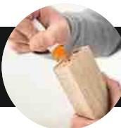
**LA BONNE PRATIQUE** En collez les trous de la première pièce et insérez les tourillons à fond. En assemblant l'autre pièce, les deux millimètres de surcote obtenus lors du perçage ménagent un petit espace qui permet d'absorber le surplus de colle sans gêner l'emboîtement.
