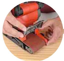
Ce modèle est doté d'un rouleau avant de faible diamètre. Avec son capot relevable, on peut poncer dans les endroits difficiles, près d'une plinthe, ou sous une rambarde.
