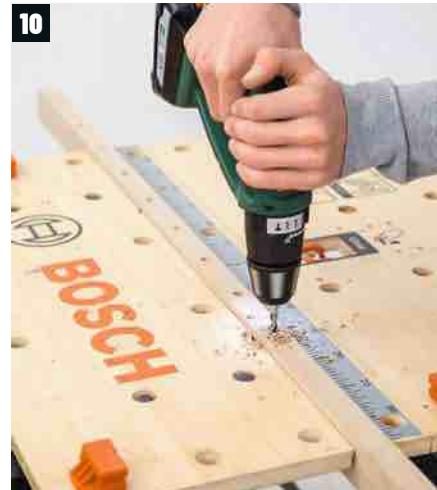
→ Enclez de même les trous d'assemblage à l'autre extrémité des longerons. Logez-y des tourillons et emboîtez le second piétement en contrôlant la perpendicularité de la structure.
