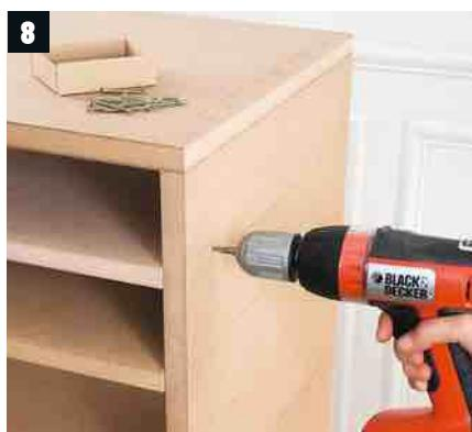
▶ Le dos est fermé par une plaque de l. 88xH. 78 cm, ép. 3 mm environ. Vous pouvez la choisir en MDF ou en fibres haute densité, type Isorel. Fixez-la avec des pointes fines dans les chants arrière de la structure.
