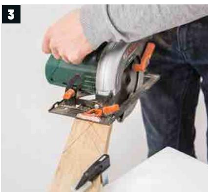
De même section que les montants, la traverse formant la barre du « A » mesure 44 cm de longueur, une fois coupée en biais à chaque bout. Procédez à un assemblage fictif et repérez ses plans de contact avec les montants.
