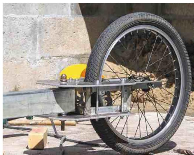
>> Florian et Quentin n'en ont gardé que l'assise et le dossier, moulés d'une seule pièce. Les tôles et tubes d'acier utilisés pour le châssis proviennent d'un chantier de démolition. Même les roulements à billes destinés à la rotation de la fourche avant ont eu une première vie, dans le domaine du karting ! Seule la quincaillerie (boulons, écrous, rondelles...) a été achetée neuve. Au total, la fabrication du chariot est revenue à 80 €.
