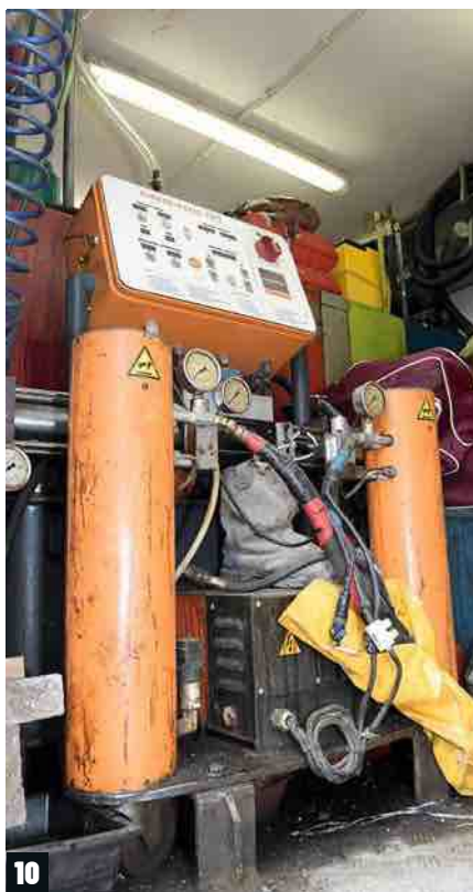
➔ L'entreprise utilise un camion équipé d'un ensemble complet d'injection : complexe de mixage, de pompage, tuyaux, câbles électriques étanches, etc.
