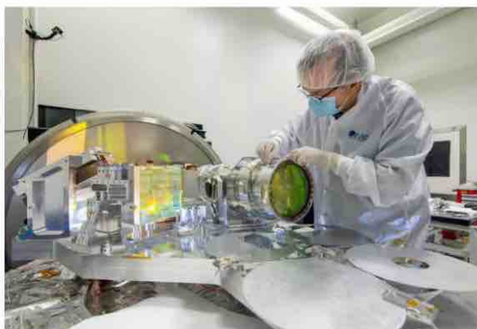
Le banc optique du spectrographe a été monté puis testé à l'Institut de recherche en astrophysique et planétologie de Toulouse. Les composants sont alignés à 20 microns près.
