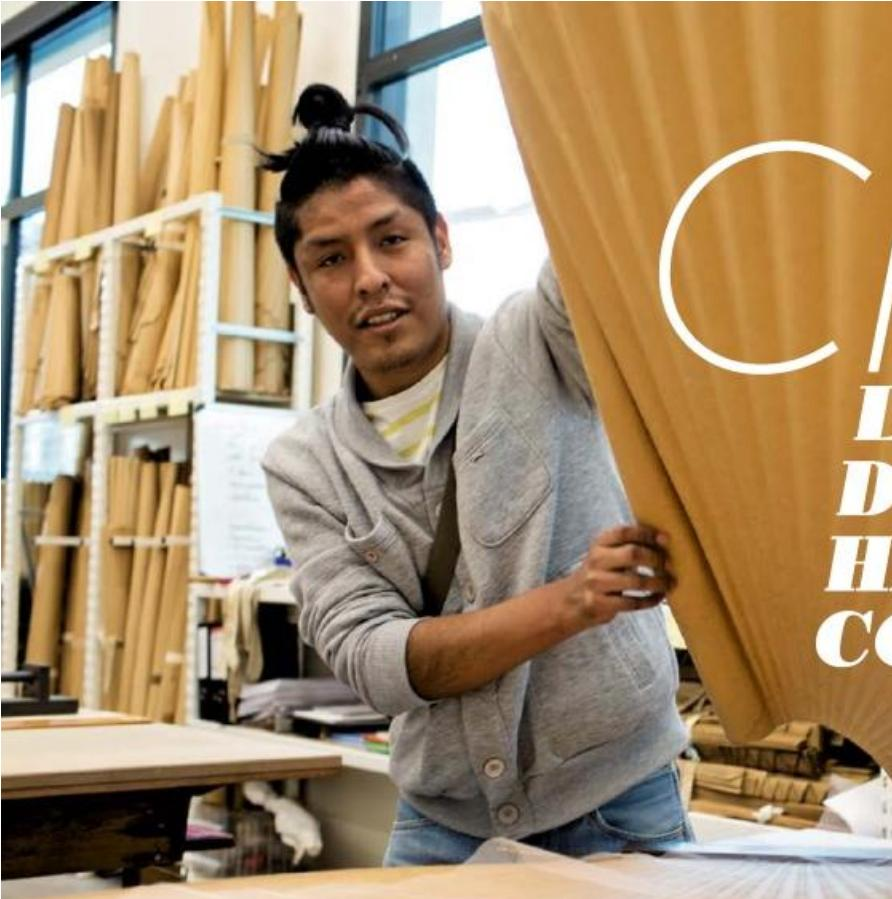
Dans l'atelier Lognon, Raphaël manie le « métier », un moule en carton, pour réaliser un plissage.
