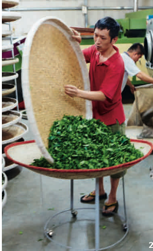
1 et 2. Les feuilles de thé sont cuites pour stopper la fermentation, et le temps de cuisson contrôlé au nez! La manufacture fonctionne jour et nuit en période de cueillette. 3. Prêtes à être dégustées, les feuilles forment des tortillons caractéristiques du thé wulong, qui s'ouvriront au contact de l'eau pour libérer tous leurs parfums.
